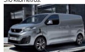
**PEUGEOT EXPERT ELÉCTRICA.-** Comparte tecnología con el Opel Vivaro-e, es decir, ofrece dos variantes, una con batería de 50 kWh y 200 kilómetros de autonomía, y otra de 75 con 300 kilómetros. Llegará en septiembre.
