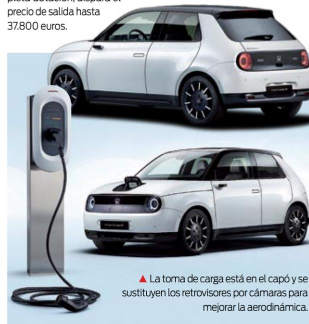
▲ La toma de carga está en el capó y se sustituyen los retrovisores por cámaras para mejorar la aerodinámica.
