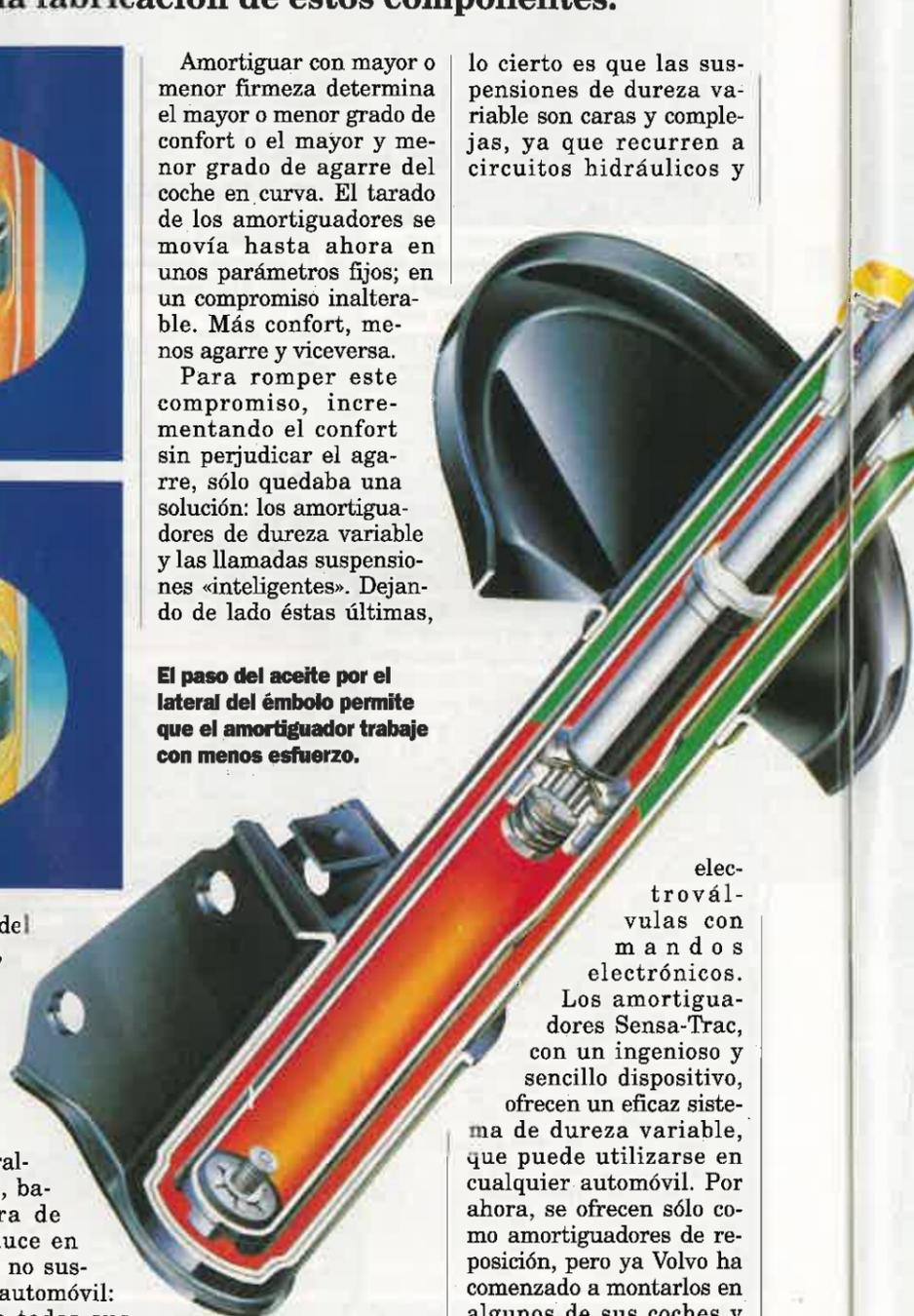
electroválvulas con mandos electrónicos. Los amortiguadores Sensa-Trac, con un ingenioso y sencillo dispositivo, ofrecen un eficaz sistema de dureza variable, que puede utilizarse en cualquier automóvil. Por ahora, se ofrecen sólo como amortiguadores de reposición, pero ya Volvo ha comenzado a montarlos en algunos de sus coches y pronto podrán aparecer
