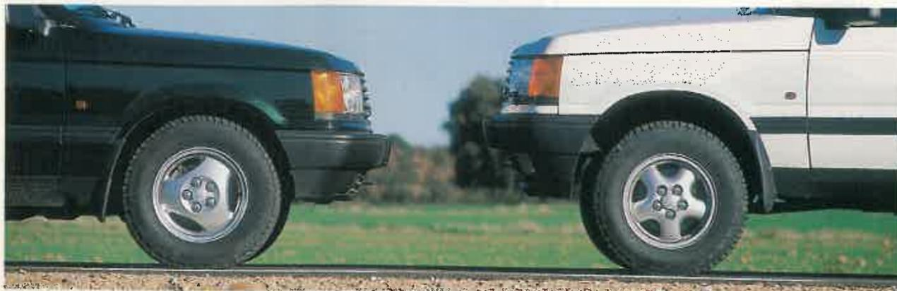
La suspensión neumática sube y baja la altura del vehículo en función de la velocidad o de las necesidades de cada momento.
