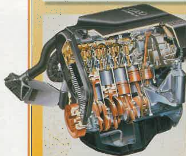
El motor del Audi de 140 caballos es exactamente igual que el de su hermano de 115 caballos pero con algunas modificaciones en la inyección.
