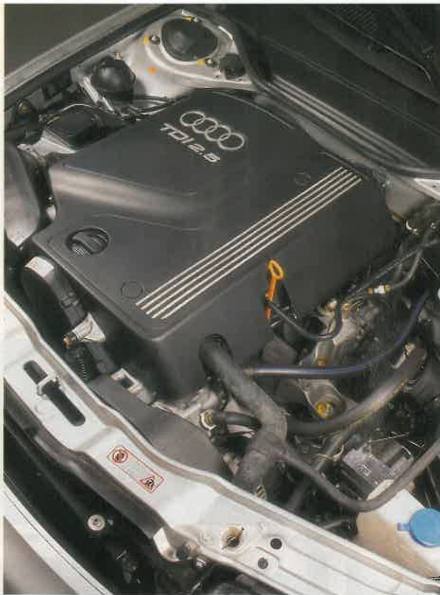
El motor en el Audi A6 está encapsulado para reducir al máximo las emisiones de ruido. Los soportes del mismo han sido estudiados de forma totalmente cuidadosa.
