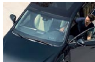
▲ Los limpiaparabrisas del NX tienen un solo punto de apoyo, en lugar de los cuatro de las escobillas convencionales. Eso elimina la necesidad del brazo de soporte, reduce el ruido y mejora la estética.
