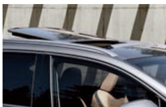
▲ La apertura del techo solar del NX es mayor que en sus competidores gracias al primer cierre con sistema de avance del mundo, que desplaza el techo solar hacia delante –en vez de hacia atrás– cuando se inclina.
