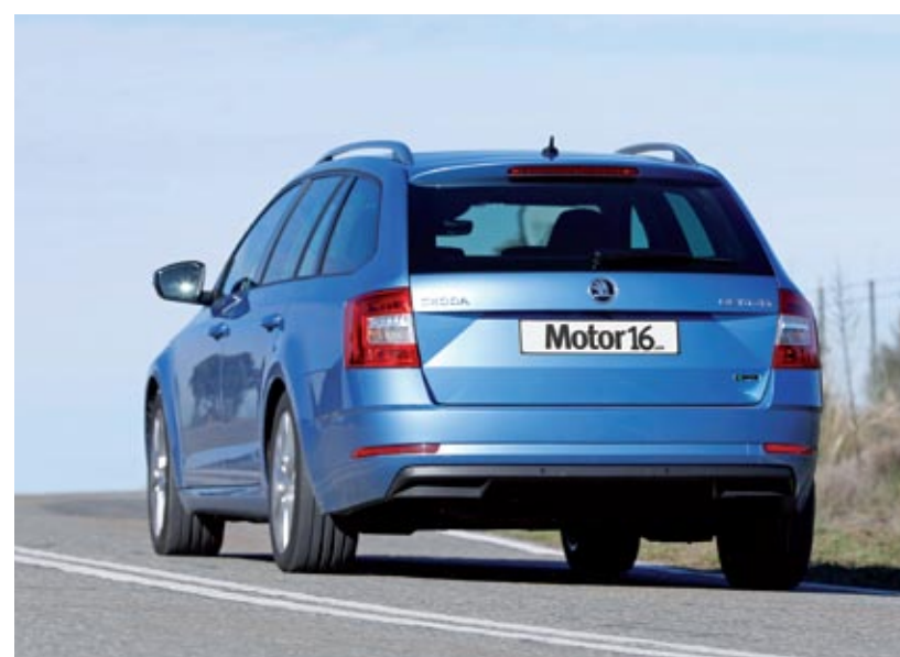
▲ Como los tanques de GNC están bajo el maletero, el escape del Octavia no va en la zaga, sino delante de la rueda trasera izquierda, lo que puede molestar algo.
