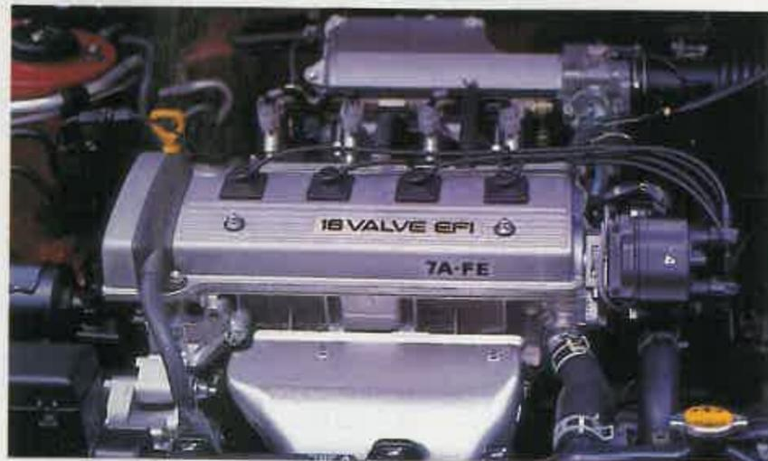
El nuevo motor de 1.800 centímetros cúbicos y cuatro válvulas por cilindro desarrolla una potencia de 115 caballos. El coche alcanza los 200 kilómetros por hora.
