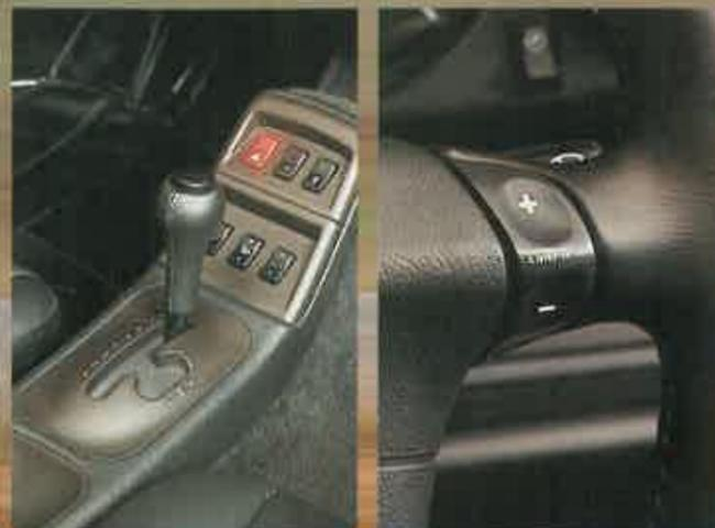
El cambio Tiptronic permite utilizar indistintamente tanto la palanca de cambios habitual como los pulsadores del volante.
