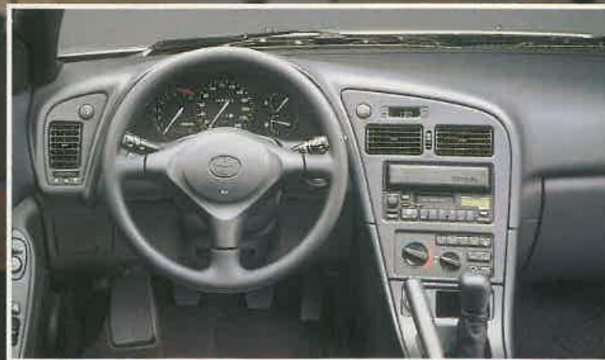
No se ofrece airbag como equipo de serie en el nuevo Toyota Celica 1.8. El volante se puede regular en altura.
