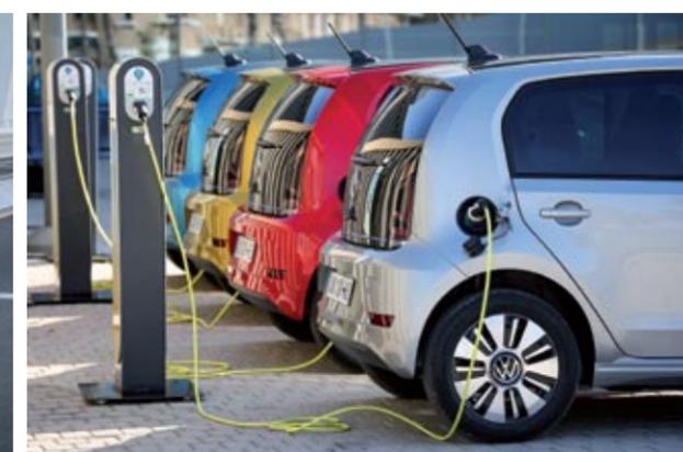
▲ El tiempo de recarga oscila entre una hora, usando una toma de 40 kW, y 16 horas en un enchufe doméstico de 2,3 kW. Con un 'wallbox' de 7,2 kW necesita cuatro horas.
