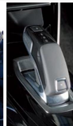
▲ El cambio automático EAT8 tiene modo manual, seleccionable a través de una tecla en la propia palanca.
