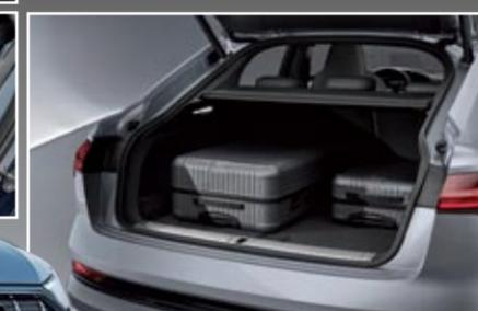
◀ Maletero posterior de 555 litros, frente a los 600 del e-tron 'normal'. La longitud y la anchura de la carrocería no varían.
