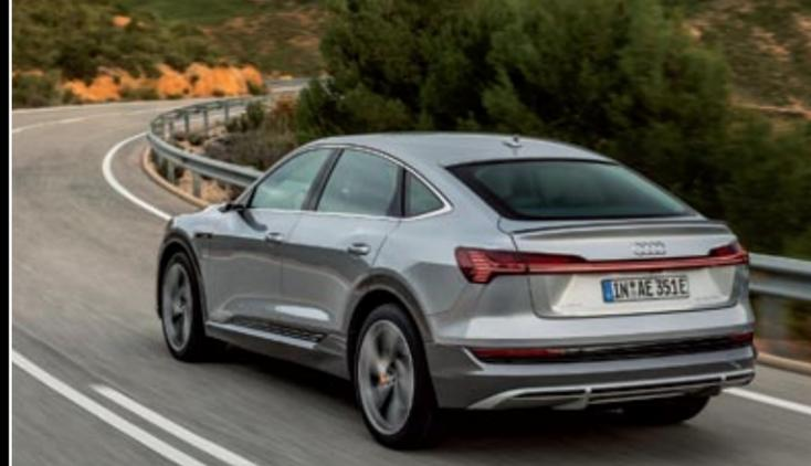
◀ El e-tron Sportback 55 Quattro homologa 446 kilómetros de alcance WLTP, 34 más que con la carrocería normal. Entre otras razones, por su mejor aerodinámica: Cx de 0,25 y 13 milímetros menos de altura.
