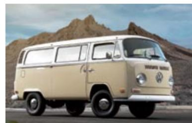
**VOLKSWAGEN BUS ELÉCTRICO.** - EV West, empresa local dedicada a convertir modelos 'normales' en eléctricos, tomó un VW Bus de 1972 y le dotó de la mecánica del e-Golf, con 136 CV. La batería, de 35,8 kWh, va debajo de los asientos delanteros y tiene 200 kilómetros de autonomía.
