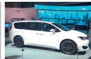
**CHRYSLER PACIFICA HÍBRIDO.**- Gana deportividad con las llantas de 20 pulgadas, los acabados exteriores negros y un interior más refinado. La versión híbrida enchufable, de 260 CV, asocia un V6 de ciclo Atkinson a una batería de 16 kWh, y recorre 48 kilómetros en modo eléctrico.
