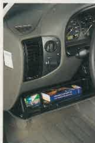
El salpicadero es sencillo, pero muy funcional. La instrumentación es suficiente para un coche de carácter utilitario como éste. Aunque las unidades probadas no lo montaban, el airbag se ofrece como opción tanto para conductor como para acompañante.
