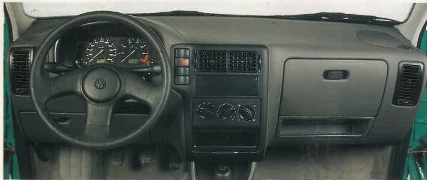
El salpicadero es sencillo, pero muy funcional. La instrumentación es suficiente para un coche de carácter utilitario como éste. Aunque las unidades probadas no lo montaban, el airbag se ofrece como opción tanto para conductor como para acompañante.
