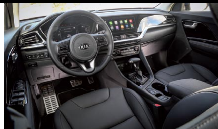
► Detalles de coche de más categoría se reflejan en un interior muy cuidado. Dice adiós al freno de estacionamiento de pie y lo sustituye por uno eléctrico. Y cuenta con levas de serie. El cuadro de instrumentos digital puede ser de hasta 7 pulgadas y la pantalla central de 10,25.
