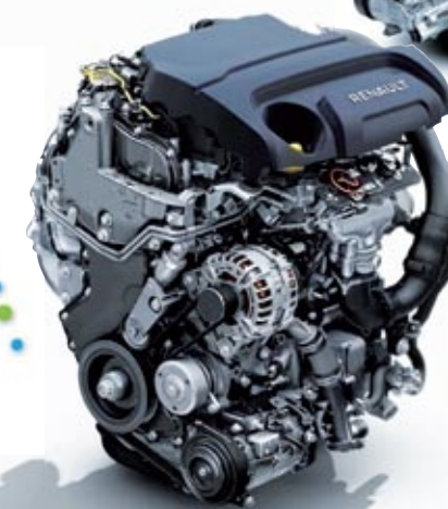
▶ Arriba, el motor TCE del Renault Mégane, con 1.332 centímetros cúbicos y disponible con seis niveles de potencia. Debajo, el renovado diésel Blue dCi 1.5, disponible con tres niveles de potencia.
