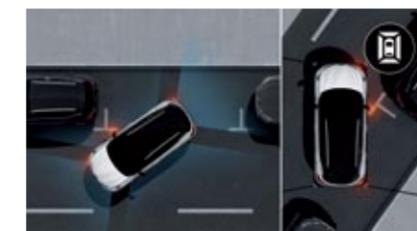
▶ La cámara de 360° utiliza cuatro cámaras que ofrecen una vista superior del coche y juntan en una sola imagen los obstáculos.
