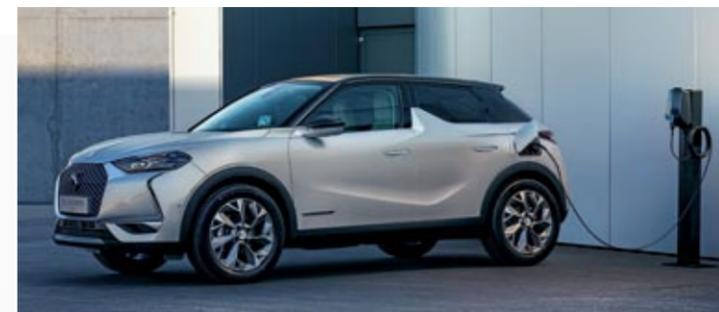
▶ En un cargador rápido de 100 kW la batería del DS 3 Crossback E-TENSE se puede cargar al 80 por ciento en apenas media hora.
