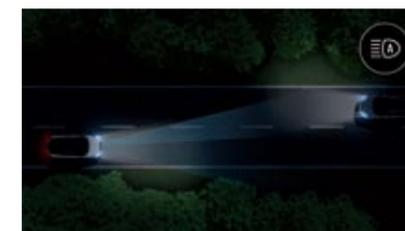
▶ Luces largas automáticas. Usa la cámara frontal para pasar de largas a luz de cruce según la luminosidad exterior y la circulación.
