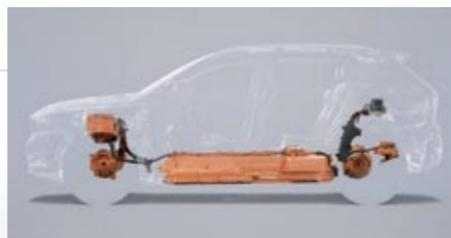
◀ Dos motores, uno en cada eje, y las baterías repartidas por el piso del vehículo.
