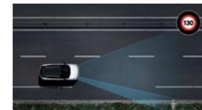
▶ El reconocimiento de señales, de serie, usa la cámara frontal para avisar al conductor automáticamente de los límites de velocidad
