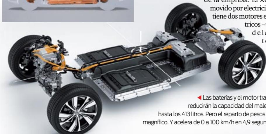
◀ Las baterías y el motor trasero reducirán la capacidad del maletero hasta los 413 litros. Pero el reparto de pesos será magnífico. Y acelera de 0 a 100 km/h en 4,9 segundos.
