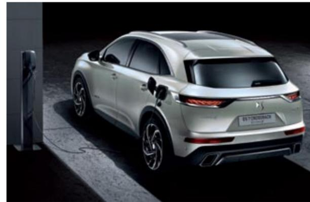
▲▼ El tiempo para recargar la batería de 13,2 kWh de capacidad oscila entre una hora y 45 minutos y ocho horas, según el sistema empleado. El conductor puede elegir entre cuatro programas de uso, incluido el '4x4', idóneo sobre superficies deslizantes.
