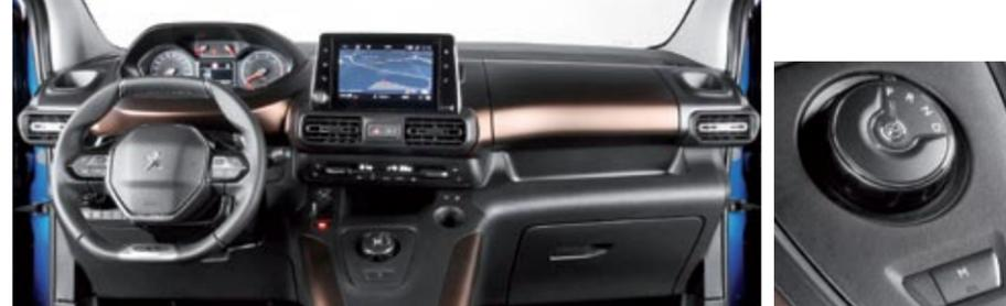
▲ El i-Cockpit condiciona su interior, donde todo está a mano. Esta pantalla de 8 pulgadas es de serie, como el climatizador de dos zonas. El selector circular del cambio no nos convence del todo.
