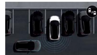
▶ La detección activa de vehículo por detrás es novedad en Renault. Utiliza radares para señalar la posible presencia de vehículos.
