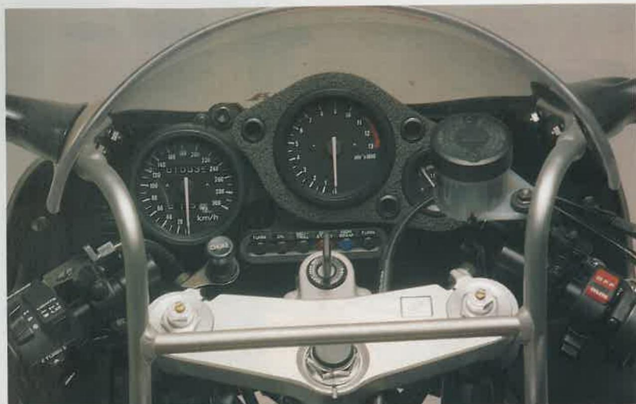
El cuadro de instrumentos es de nuevo diseño, ofreciendo una lectura más clara y precisa. Por su parte, la suspensión trasera ofrece un tacto muy firme, condicionado sobre todo por el escaso recorrido que tiene el amortiguador, apenas 112 milímetros.
