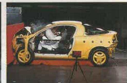
**El Opel Tigra puede incorporar dos airbags de gran tamaño. El del conductor tiene un volumen de 67 litros de aire y el del acompañante tiene 100 litros. Cuenta con pretensores, asientos con rampas antideslizamiento y dirección de seguridad.**
