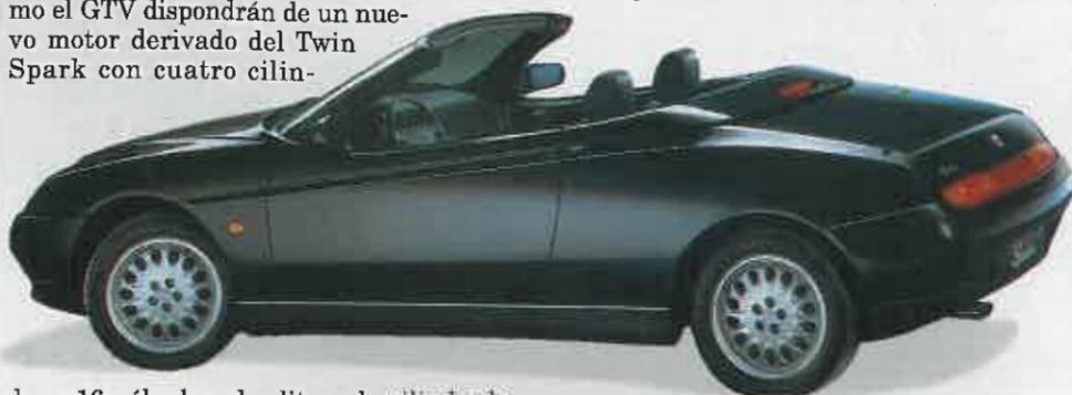
dros, 16 válvulas, dos litros de cilindrada y 150 caballos de potencia dotado de variador de fase y con doble encendido por cada cilindro. El nuevo descapotable italiano también se ofrecerá con el clásico V6 de 3 litros con 192 caballos y el coupé cerrado GTV con un V6 sobrealimentado de dos litros actualmente montado en
