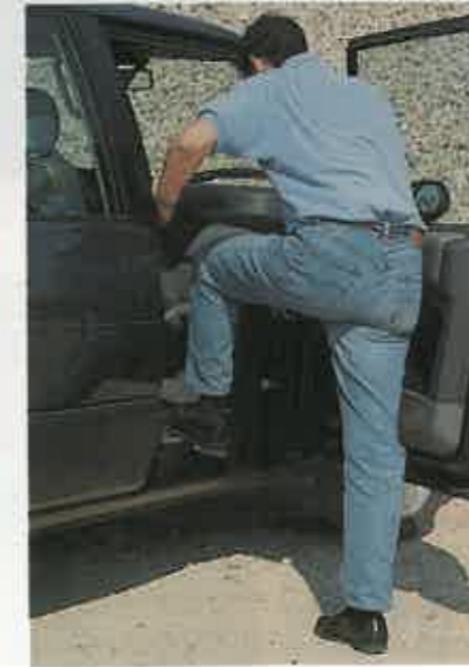
La altura del portón es escasa en el Espace y es fácil tocar con la cabeza al descargar. La altura del piso es ligeramente más baja en el Espace que en sus rivales.
