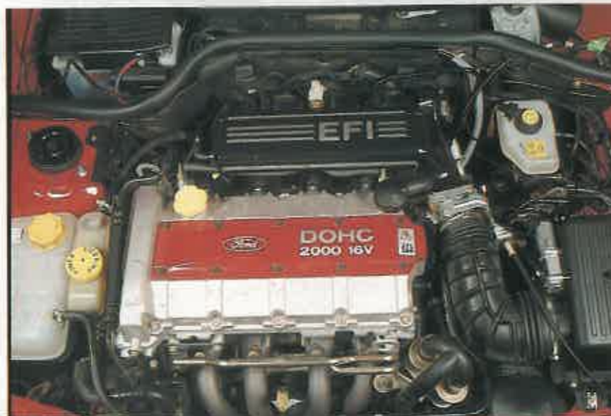
El moderno motor multiválvulas de dos litros y 150 caballos de potencia acusa el mayor peso del coche y la necesidad de tener que mover las cuatro ruedas motrices.
