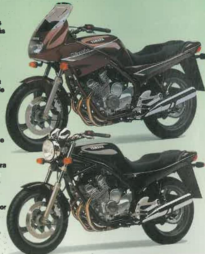
gamillas. En la suspensión delantera nos encontramos con una horquilla convencional con barras de 41 milímetros de diámetro y un recorrido de 140. Detrás, anclado al monobrazo de transmisión, un amortiguador regulable en precarga de muelle trabaja siguiendo un esquema de progresividad variable, el conocido «monocross» de la casa que en esta ocasión tiene 110 milímetros de recorrido.
