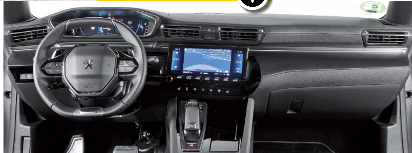
▲ El cuadro de instrumentos tiene varios diseños, al igual que la pantalla central. Junto al selector del cambio va el botón para elegir entre los modos de conducción.
