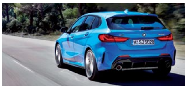
▲ La doble salida de escape trasera se asocia a los motores de cuatro cilindros, mientras que la salida individual está ligada a los de tres.
