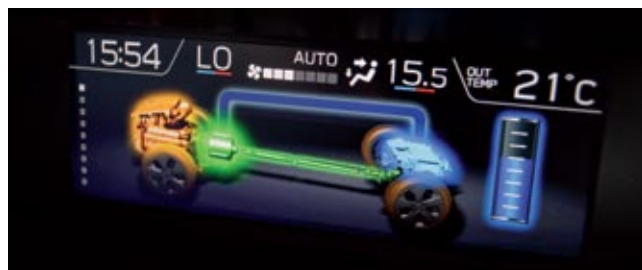
▲ En la pantalla central se indica en todo momento cómo trabaja el sistema ecoHybrid y cada uno de los tres modos de funcionamiento.
