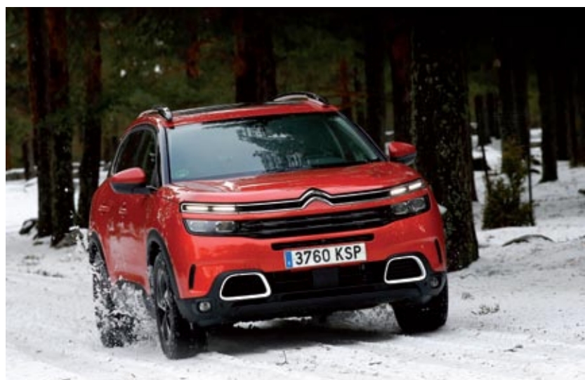
◀▶ El Grip Control optimiza la acción del sistema antipatinamiento, pues permite al conductor elegir entre cinco programas, cada uno con su reglaje.
