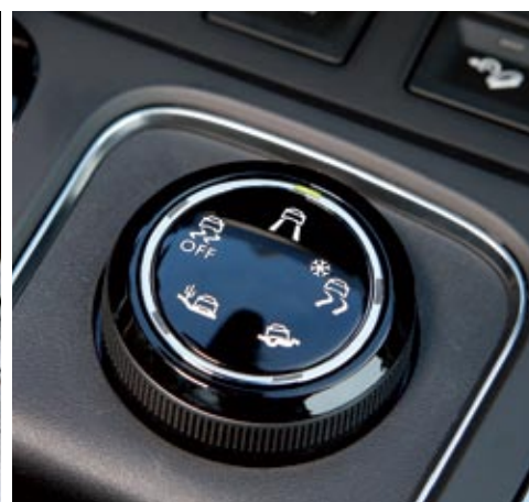
◀▶ El Grip Control optimiza la acción del sistema antipatinamiento, pues permite al conductor elegir entre cinco programas, cada uno con su reglaje.
