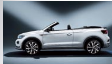
► Hasta 30 km/h se puede accionar la capota en marcha y se abrirá o cerrará en 9 segundos. También se maneja desde el mando a distancia.
