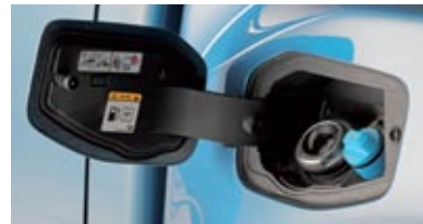
▲▲ La boca de llenado de gasóleo, que no lleva tapón, va acompañada de la del rellenado de AddBlue de cara a reducir las emisiones. Los neumáticos son brutales.
