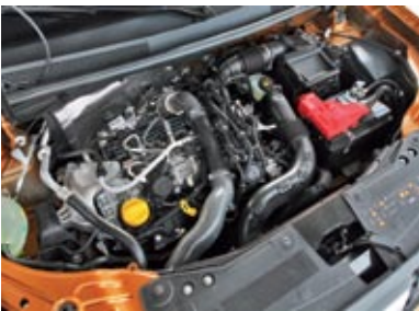
▲ El nuevo propulsor 1.3 TCe lo comparte con Renault, Nissan y Mercedes, aunque en el caso del Duster rinde 130 caballos.
