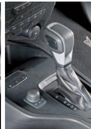
▲ El cambio automático de 10 marchas es una delicia y lleva levas en el volante. La tracción permite ir en tres modos.
