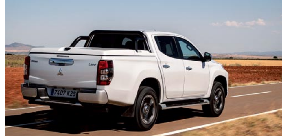
▲ El chasis retoca la suspensión delantera e incorpora una sexta lámina en las ballestas traseras. La capacidad de carga y de movilidad 'off road' es sobresaliente, pero los rebotes del eje trasero siguen siendo evidentes.
