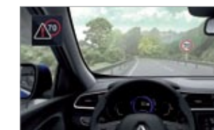
▲ Reconocimiento de velocidad de las señales de tráfico.
