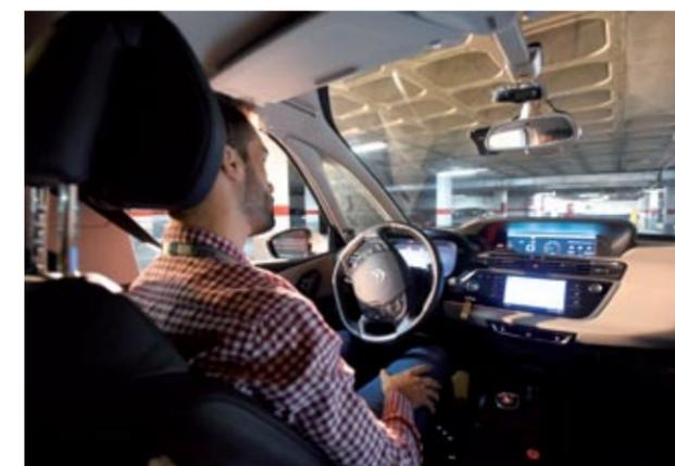
► Un conjunto de radares y sensores permiten al autónomo de PSA aparcar, entrar y salir del parking, o circular por la ciudad sin intervención.
