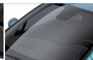
▲ El parabrisas acústico reduce la sonoridad interior y se suma al silencio del motor eléctrico.
