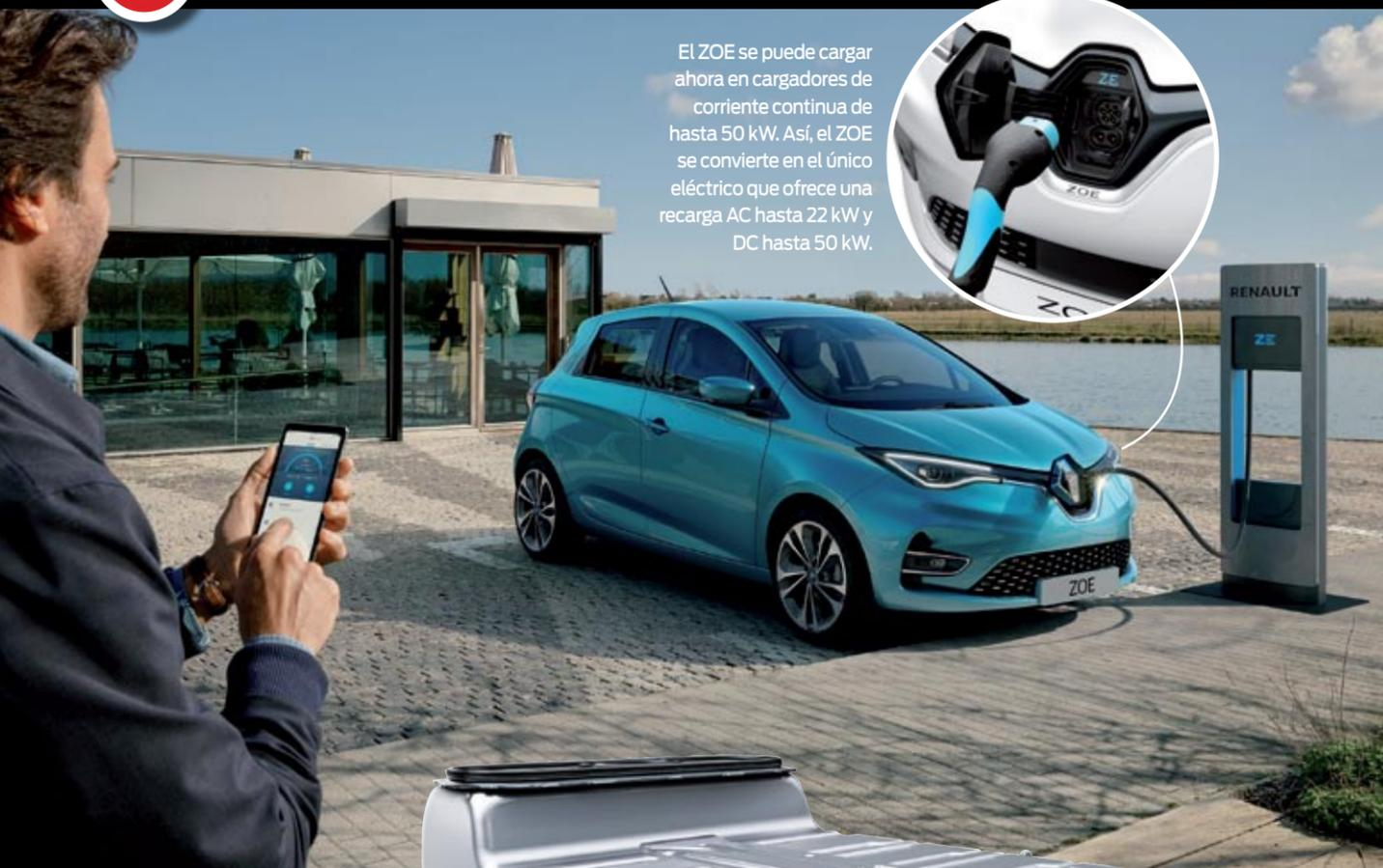
El ZOE se puede cargar ahora en cargadores de corriente continua de hasta 50 kW. Así, el ZOE se convierte en el único eléctrico que ofrece una recarga AC hasta 22 kW y DC hasta 50 kW.
