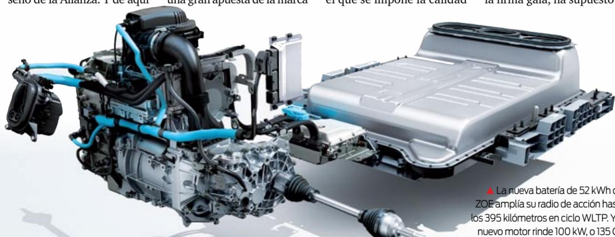
▲ La nueva batería de 52 kWh del ZOE amplía su radio de acción hasta los 395 kilómetros en ciclo WLTP. Y el nuevo motor rinde 100 kW, o 135 CV.
