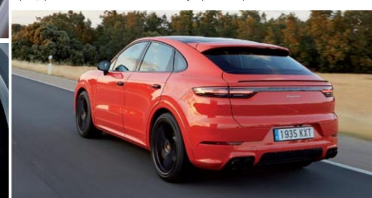
▲ No hay techo panorámico que se abra. Sus llantas pueden ser de hasta 22 pulgadas y los frenos PSCB, con recubrimiento de wolframio para evitar el hollín, es de serie en el Turbo y opcional en el resto. El alerón se eleva al superar los 90 km/h y trabaja junto con el que hay al final del techo.
