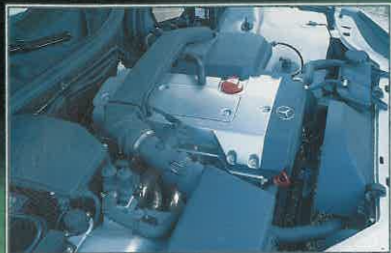
El prototipo va provisto de un motor de 2,2 litros de cilindrada y 150 caballos.
