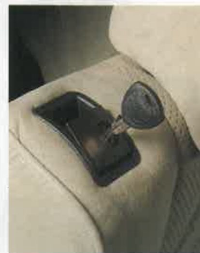
En el interior del Lancia Delta TB DS LE se encuentran muchos detalles. Los asientos traseros abatibles tienen cerradura, los retrovisores y los elevalunas traseros (en opción) funcionan eléctricamente y el asiento del conductor es multirregulable.
