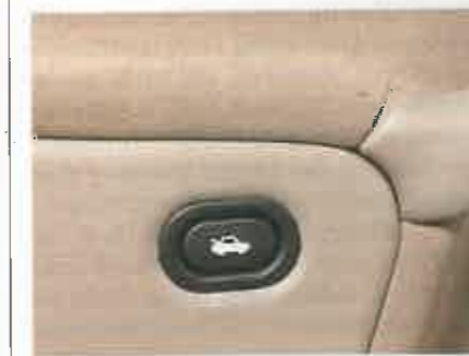
El maletero se puede abrir desde el botón situado en la puerta del conductor.
