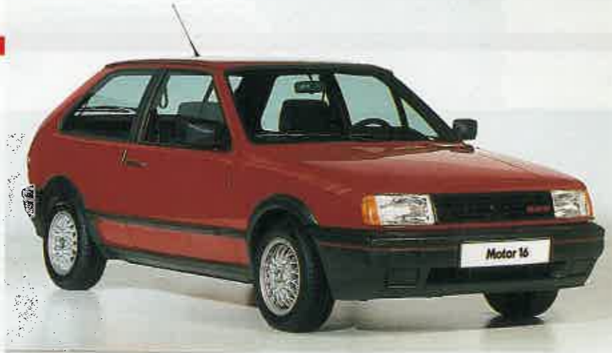
El predecesor del nuevo GT fue el Polo G-40, dotado de un motor con un compresor volumétrico. A pesar de su buen rendimiento, ha dado paso a una mecánica nueva.
