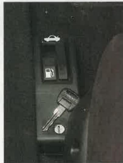
El Accord dispone de un mando interior para abrir el maletero y el depósito.
