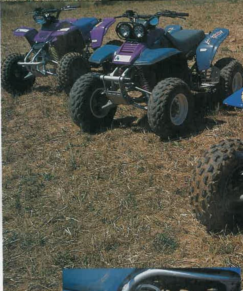
El motor del Banshee es un bicilíndrico de dos tiempos y 350 c.c., con una potencia de 47,4 caballos y refrigeración líquida. El cambio es de 6 marchas.
