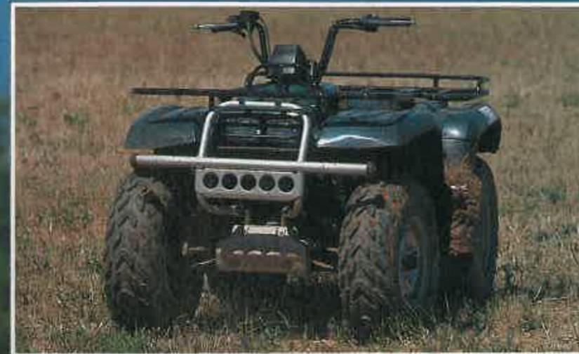
En la gama de los ATV de Yamaha, el modelo Kodiak es el más grande. Tiene un motor de 396 c.c. y tracción integral. La suspensión delantera es de doble brazo.
