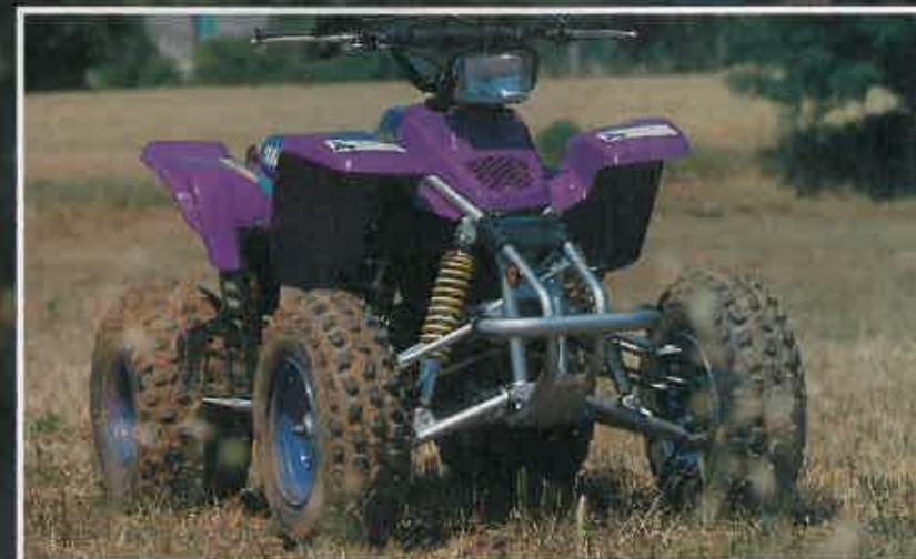
El Quad Blaster monta un motor monocilíndrico de 200 c.c. con cambio de cinco velocidades. No tiene arranque eléctrico ni marcha atrás. Es muy ligero.
