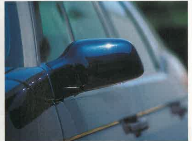
Nuevos retrovisores para toda la gama XM, con un dispositivo eléctrico que orienta el espejo hacia el suelo cuando se engrana la marcha atrás.
