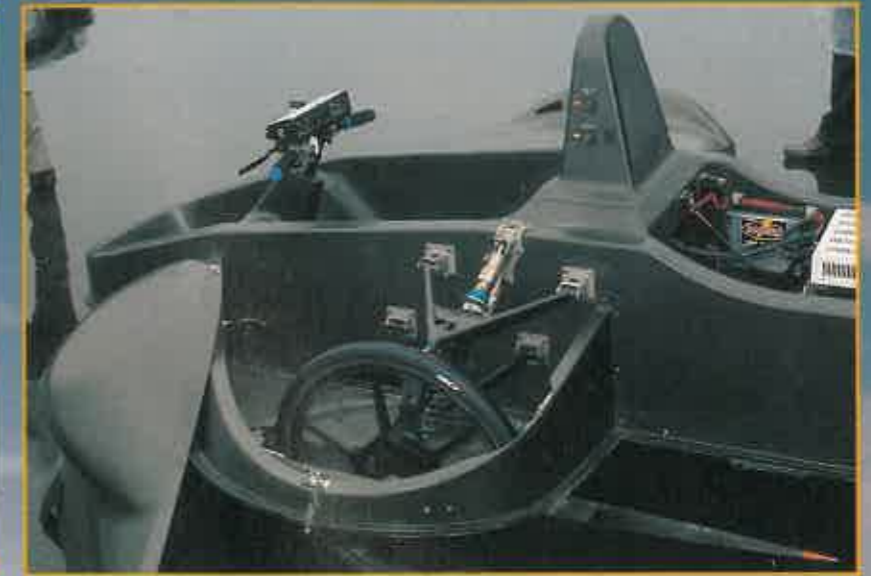
El motor eléctrico está alojado en la misma rueda para evitar pérdidas de energía por rozamiento. La suspensión es un monobrazo y las ruedas son macizas. El panel de instrumentos (centro) mantiene informado al piloto del estado de carga del coche, así como de su velocidad. La suspensión delantera (derecha) tiene un esquema de doble triángulo, con un amortiguador en cada rueda.
