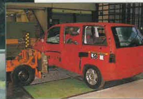
Choque lateral según las normas que se van a imponer en la Unión Europea.
