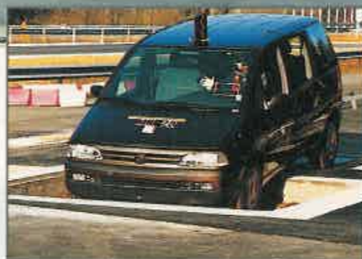
Pista de baja adherencia (foto superior) y prueba en zanja para calibrar el disparo de los airbag.
