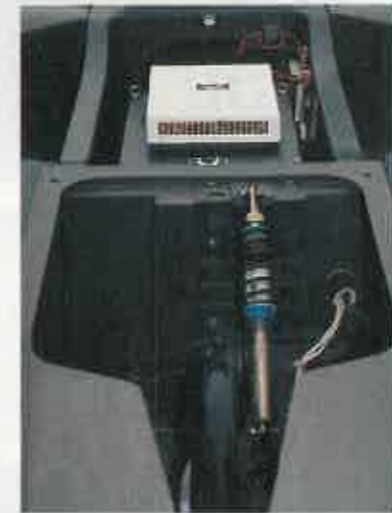
En la parte delantera puede verse la rueda motriz. Arriba, el acumulador.
