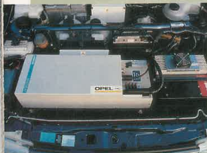
El motor eléctrico sólo pesa 50 kilos. Actúa como generador en el momento de frenar y no se pierde energía.
