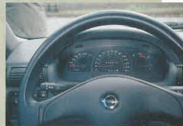
En lugar del indicador de gasolina, un amperímetro/hora indica lo que queda de batería.
