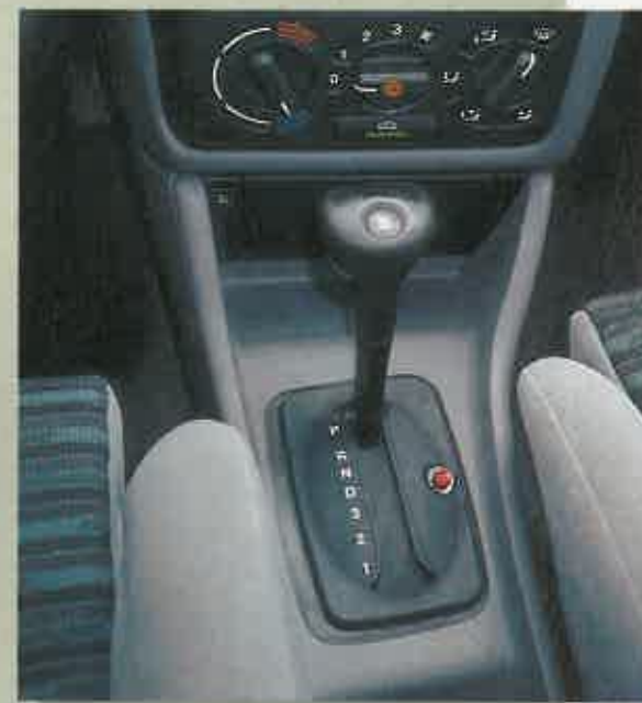
La palanca de transmisión es similar a la de un automático pero con menos posiciones.
