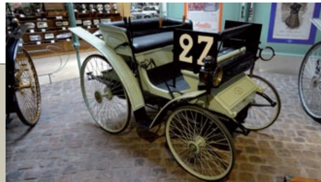
▲ El Peugeot Type 5 ganó en 1894 la primera carrera automovilística del mundo entre París y Rouen. Con 2 cilindros, alcanzaba los 18 km/h.
