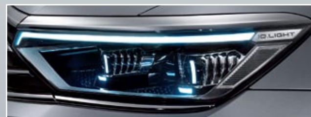
▲ El nuevo Passat es el segundo Volkswagen, tras el Touareg, que cuenta con faros matriciales LED IQ.LIGHT.
