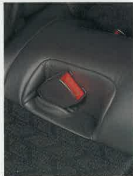
El anclaje de los cinturones de seguridad de la parte trasera va escamoteado.
