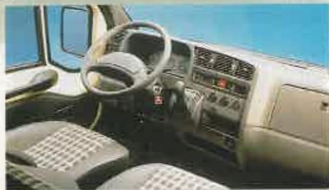
dro, dos de admisión y una de escape con unas potencias de 86 y 103 caballos. Siguiendo con la mecánica, hay que resaltar que este nuevo modelo utiliza dos tipos de caja de cambios: la MG, que es nueva y la ME, que es similar a la del XM. La particularidad del cambio es que la palanca está situada en el salpicadero, muy al alcance de la mano, resultando su manejo muy cómodo.
