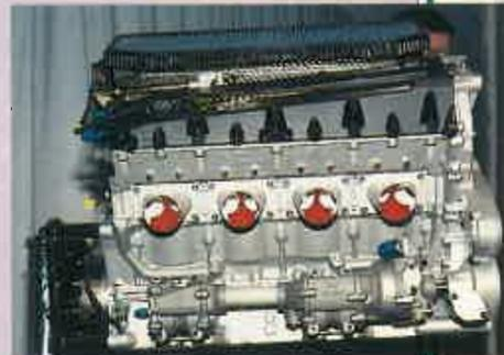
el HB, tener un diámetro de pistón de 99,75 milímetros, cuatro válvulas por cilindro no radiales y la admisión por medio de válvulas cilíndricas giratorias, le situaba en un lugar muy peculiar entre los motores de F1.
