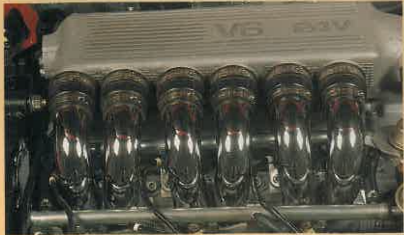
El Alfa Romeo Coupé contará con uno de los mejores motores de seis cilindros, el que monta el 164 Q4 de seis cilindros en V, 24 válvulas y tres litros de cilindrada con 230 caballos de potencia. El Coupé de Alfa se llamará GT.
