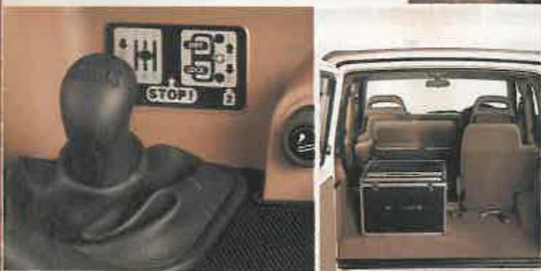
Esta palanca controla las reductoras y el bloqueo del diferencial central.
