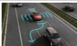
▲ El Emergency Assist detiene el vehículo en el arcén de manera controlada en caso de emergencia.
