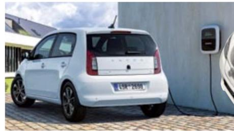
▶ El primer modelo eléctrico de Skoda es este Citigo IV. El motor tiene una potencia de 83 caballos y la autonomía alcanza los 265 kilómetros.
