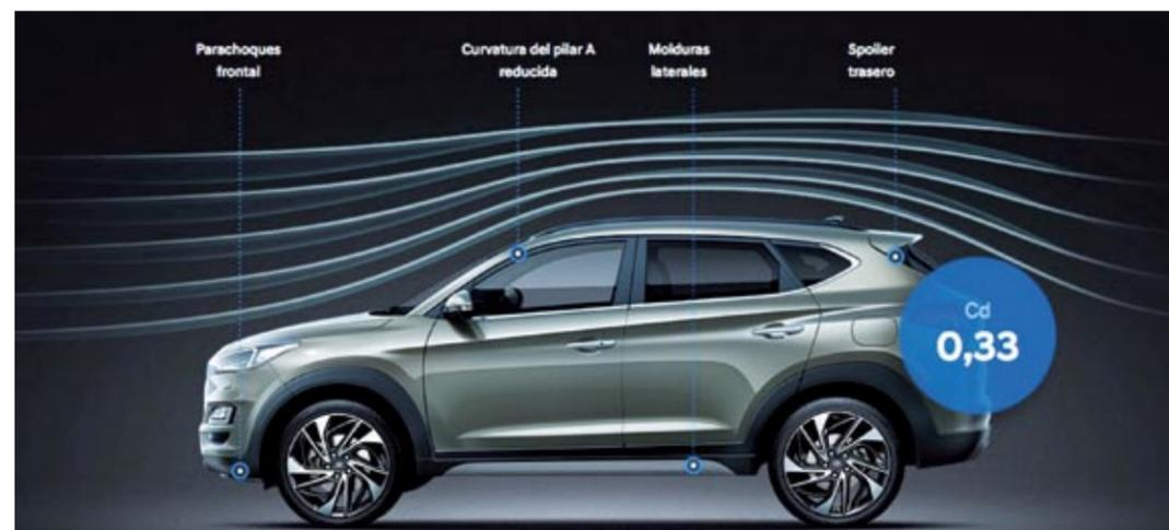
◀ El nuevo Tucson presume de un coeficiente aerodinámico sobresaliente, que rebaja el consumo e incluso mejora la estabilidad del vehículo a alta velocidad.
