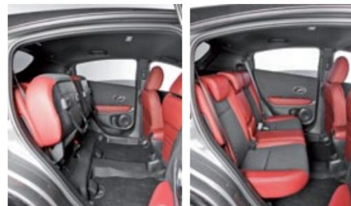
◀▲ Los nuevos asientos son cómodos y sujetan, y detrás se mantiene la segunda fila con Magic Seat System, que permite alzar la banqueta para cargar cosas.
