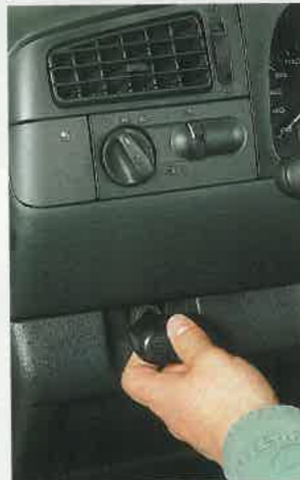
Un obsoleto mando del starter sólo se utiliza cuando hace mucho frío. Los elevalunas y retrovisores exteriores se regulan de forma eléctrica.
