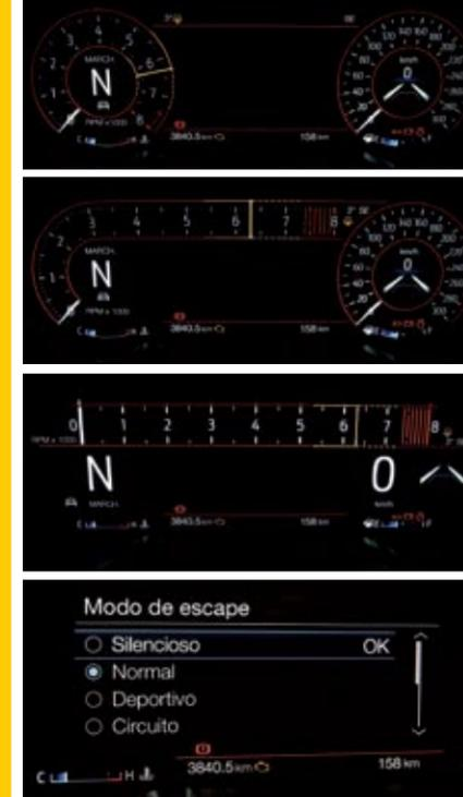
▲▲ La instrumentación es una pantalla de 12 pulgadas con diseño y contenido configurables. Y podemos elegir cuatro sonidos de escape, incluido el 'silencioso', con horario programable.
