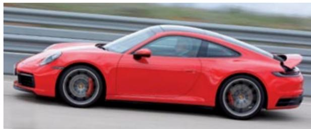
▲ El alerón se despliega en dos fases, a 90 y a 170 km/h. E incluso en una frenada fuerte adopta una posición casi vertical para ayudar.
