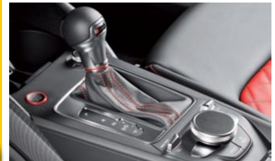
▲ El cambio S tronic de siete marchas es una maravilla. Tiene modo secuencial y levas. Ofrece cinco modos de conducción, desde el Efficiency al Individual, que deja personalizar dirección, motor, cambio, sonido... El Audi Virtual Cockpit y el navegador MMI son de serie, pero la pantalla central es fija y no táctil.
