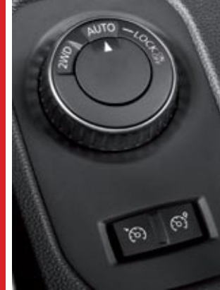
◀ Una rueda permite elegir el tipo de tracción: delantera, 4x4 de reparto variable y 4x4 de reparto fijo, este último activo hasta 60 km/h.
