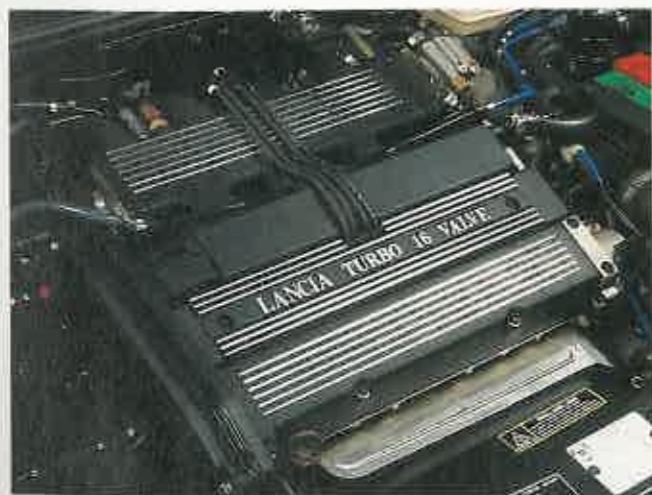
Se trata de un motor ya utilizado por la marca Italiana en otros modelos. Proporciona una potencia de 190 caballos.
