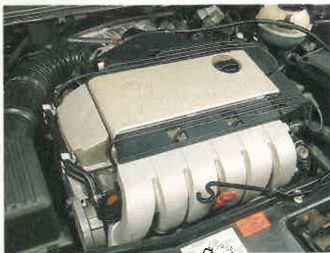
Son seis suaves y progresivos cilindros en V estrecha que rinden 174 caballos. Sorprenden las cifras obtenidas.
