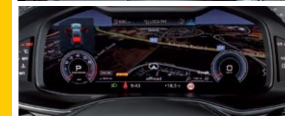
▲ Hasta la climatización se controla desde una pantalla táctil de 8,8 pulgadas. La superior tiene 10,1 y el Virtual Cockpit, 12,3. Pero son opcionales.
