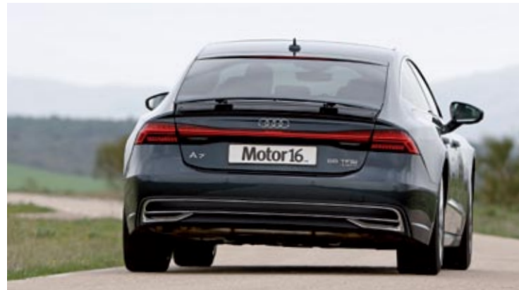
▲ El alerón activo emerge al superar 120 km/h y los pilotos LED van ‘conectados’ entre sí. El A7 Sportback es tan cómodo como deportivo.
