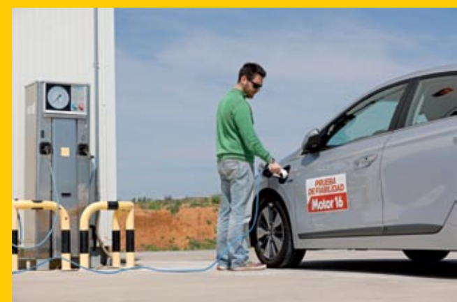
▶▶ Tras 2 horas y 40 minutos enchufado a un cargador de alta capacidad, el Ioniq Plug-in puede cubrir 63 kilómetros sin emisiones. En un enchufe normal doméstico tarda 4 horas y 25 minutos.
