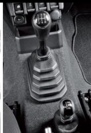
◀ El Jimny circula en tracción trasera, pero el 4x4 se puede engranar hasta 100 km/h. Lleva reductora y descenso de pendientes. El volante solo se regula en altura y el maletero es mínimo.
