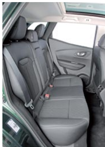
◀▶ El interior es amplio y los asientos son ahora más confortables al incorporar nuevos mullidos. La capacidad del maletero oscila entre los 472 y 1.478 litros, y se pueden introducir objetos de hasta 2,56 metros de largo si abatimos el respaldo del copiloto. La rueda de repuesto de uso temporal es opcional.
