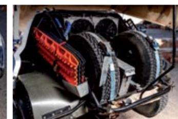
▲ Solo en la parte central del salpicadero hemos contado hasta 43 interruptores, a cada cual más importante. Detrás lleva dos ruedas de repuesto y las planchas para salir de una trampa de arena o afianzar los gatos automáticos. Los radiadores van delante, algo expuestos.
