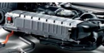
**NO** es necesario enchufarla, se autorrecarga. La potencia sobrante del motor de combustión la recarga. Eso ahorra la utilización de engorrosos cables.
