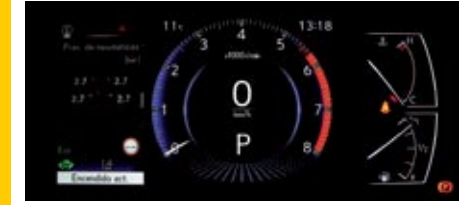
▲ La instrumentación es configurable, y el indicador grande central puede ser velocímetro, cuentavueeltas o un potenciómetro donde ver cómo gastamos o regeneramos la energía.
