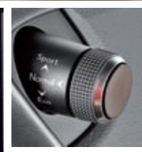
▲▲ La rueda para elegir entre Sport, Normal y Eco va muy a la vista, sobre la capilla de la instrumentación. Detrás no sobra altura al techo.
