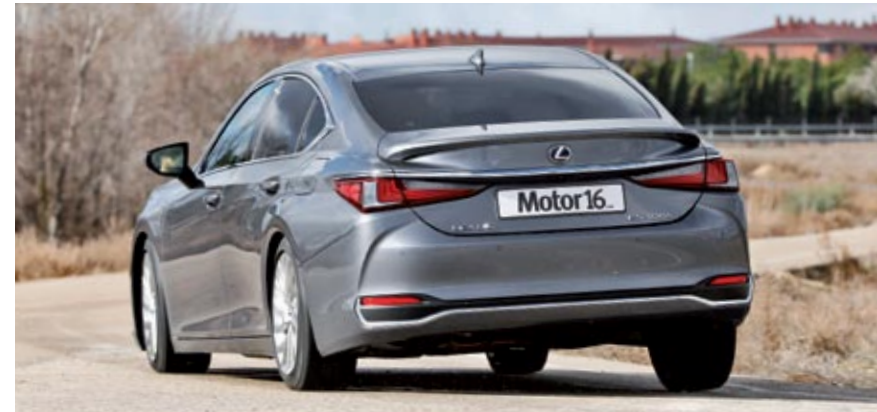
◀ El ES 300h estrena suspensión, pues adopta los amortiguadores con válvula oscilante y su esquema trasero de doble triángulo es nuevo. El equilibrio es magnífico, pues hay mucho confort pero también una notable estabilidad.
