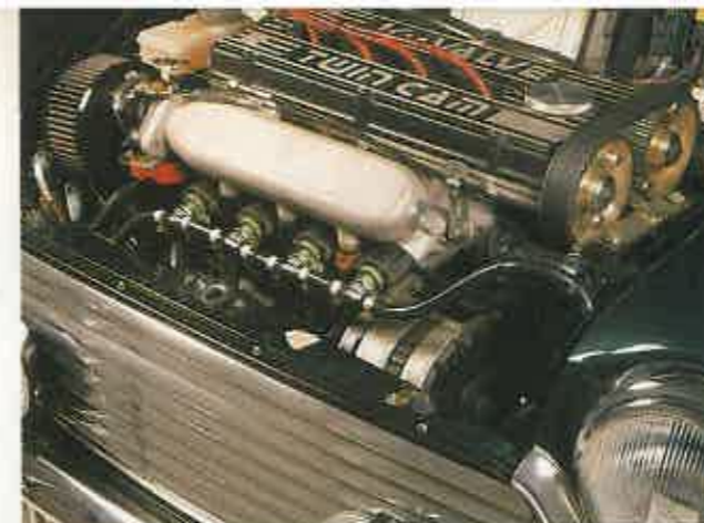
DOBLE ARBOL Culata de 16 válvulas y más cilindrada para obtener la cifra sorprendente de 135 caballos de potencia.
