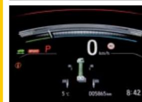
◀ El gráfico que muestra el modo de conducción tras el volante es pequeño, y conviene no ir mirándolo demasiado tiempo por las posibles distracciones. Hasta más o menos 90 km/h el sistema de tracción total manda fuerza a las cuatro ruedas, y a partir de esa velocidad sólo a las ruedas delanteras, siempre que el sistema no detecte que hace falta. Una de las pantallas muestra el reparto de par por cada rueda.
