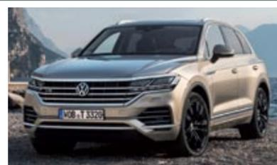
**VOLKSWAGEN TOUAREG V8 TDI.-** Estreno del diésel 'gordo' del Touareg, con 421 CV de potencia y par máximo de 91,8 mkg, y que cumple la norma de emisiones Euro 6d-TEMP. Equipa de serie suspensión neumática, tracción 4Motion y cambio automático de 8 marchas. De 0 a 100 km/h en 4,9 segundos.
