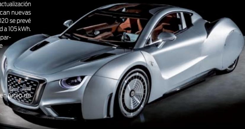
▲▼ El Hispano Suiza Carmen cuenta con dos motores eléctricos situados en las ruedas traseras, con un total de 1.019 CV. El 'hyperlux' fabricado en España pesa 1.690 kilos y acelera de 0 a 100 km/h en menos de 3 segundos.
