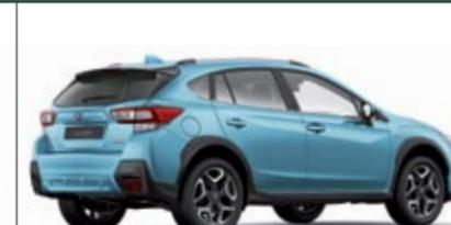
**SUBARU XV MILD HYBRID.** Porta la misma tecnología híbrida e-Boxer que el Forester, es decir, un motor térmico de gasolina de dos litros y configuración boxer con 145 CV, un propulsor eléctrico de 13,6 CV, una batería de iones de litio de solo 0,6 kWh y la eficaz tracción total simétrica de Subaru.
