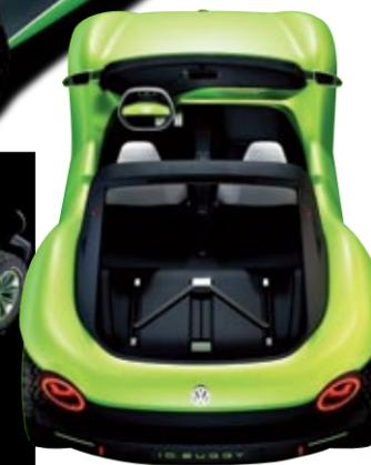
▶▶ El ID. Buggy mide 4,06 metros de largo por 1,89 de ancho y 1,46 de alto, y acelera de 0 a 100 km/h en 7,2 segundos. Bajo el suelo, entre los ejes, monta una batería de 62 kWh que permite recorrer 250 kilómetros.
