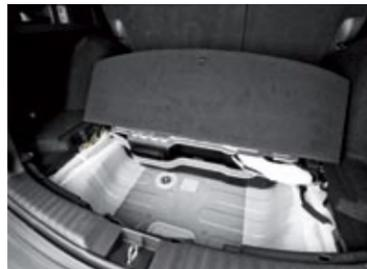
▲ Bajo el maletero hay un hueco para el kit de reparación porque, por las baterías, el CR-V Hybrid no puede llevar rueda de repuesto. Pero el maletero es muy capaz.
