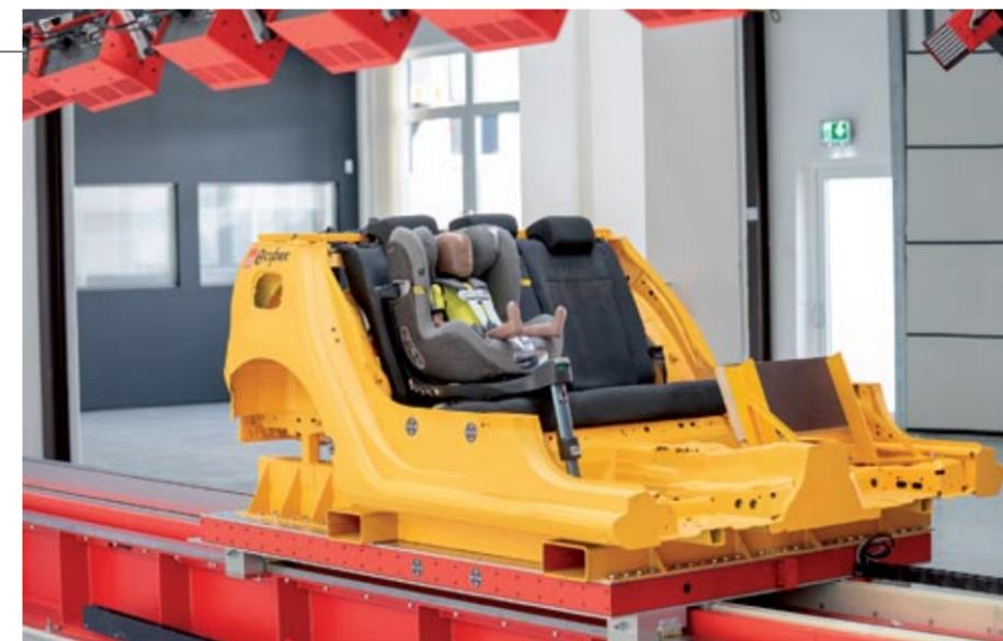
▲ La plataforma es impactada por un émbolo, para reproducir impactos frontales de hasta 80 km/h, laterales de entre 25 y 50 km/h, y choques posteriores de hasta 75 km/h.
