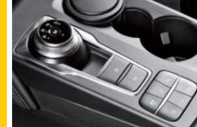
▲▼ El cambio automático no es de doble embrague, sino de convertidor. Y tiene ocho marchas y modo manual, con levas en el volante. El Focus Active agrega dos modos de conducción más: Resbaladizo y Pista.
