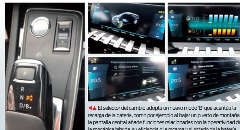
◀▶ El selector del cambio adopta un nuevo modo 'B' que acentúa la recarga de la batería, como por ejemplo al bajar un puerto de montaña. Y la pantalla central añade funciones relacionadas con la operatividad de la mecánica híbrida, su eficiencia o la recarga y el estado de la batería.
