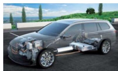
▲ **Volkswagen Passat GTE.** - El Passat híbrido enchufable monta ahora una batería de 13 kWh que le otorga una autonomía eléctrica de hasta 55 kilómetros (WLTP). Y la potencia total es de 218 CV.
