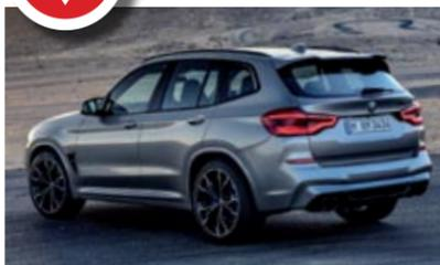
▲ **BMW X3 M.** - El primer X3 con el logo M cuenta con un motor de seis cilindros en línea, 3,0 litros de cubicaje, sistema twin-turbo y 480 caballos de potencia. Acelera de 0 a 100 km/h en 4,2 segundos.
