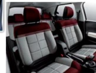
badenes sin transmitir al interior malas sensaciones. Y los asientos, que se anclan sobre el chasis, se han diseñado para evitar que las vibraciones generadas por el terreno se transmitan a los pasajeros gracias a un material viscoelástico sobre un espumado más tradicional. Además de cuidar la postura y el tapizado.
