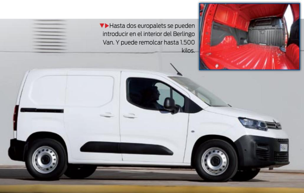
▶ Hasta dos europalets se pueden introducir en el interior del Berlingo Van. Y puede remolcar hasta 1.500 kilos.
