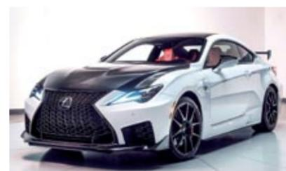
▲ **Lexus RC F Track Edition.** - Esta serie limitada rebaja hasta 80 kilos el peso, equipa frenos cerámicos, tiene un escape fabricado en titanio y emplea unas llantas forjadas BBS de 19 pulgadas.
