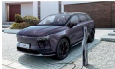
▲ **Aiways U5.** Este proveedor de soluciones de movilidad con sede en Shanghai presenta un SUV eléctrico, cuya aerodinámica carrocería —Cx de 0,29— combina aluminio y aceros de alta resistencia.
