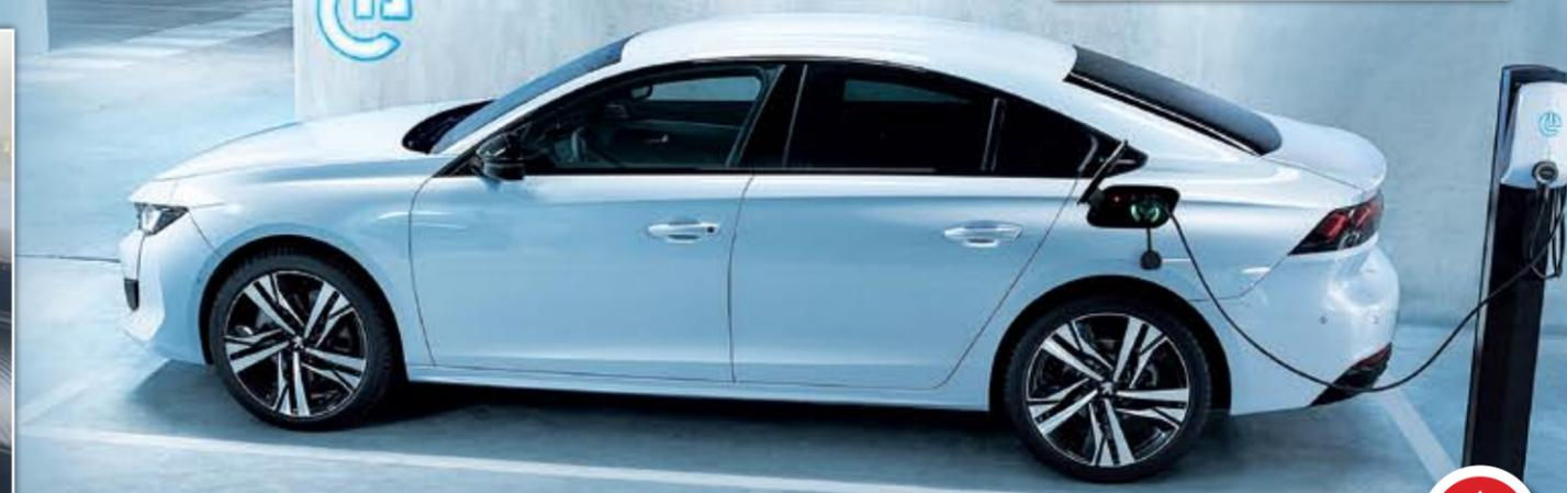
EN MODO ELÉCTRICO ALCANZA 135 KM/H Y PERMITE ACELERAR CON CIERTA FUERZA. SI ACELERAMOS A FONDO, EL PURETECH ACTÚA
