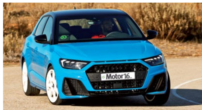
◀ Nuestro A1 tenía suspensión activa con dos modos y unas llantas de 18 pulgadas con gomas 215/40, también opcionales. Eso sí, con ambos elementos su dinámica no tiene que envidiar a la de muchos deportivos.
