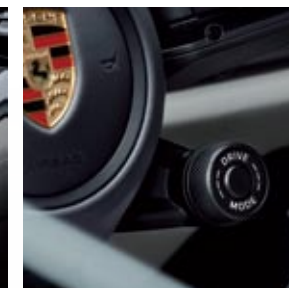
▲ El interior del 911 ha sufrido una importante transformación, mezclando lo digital con guiños al pasado. Desaparece la ranura de contacto, y el nuevo modo Wet se puede activar desde un mando junto al volante.
