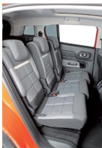
▲ En el salpicadero hay ocho toberas de aireación –en realidad son cuatro dobles–, y detrás también hay aireadores centrales. La segunda fila está formada por tres butacas independientes e iguales, y cada una tiene múltiples ajustes. Los asientos son muy cómodos, pero deberían sujetar un poquito más.
