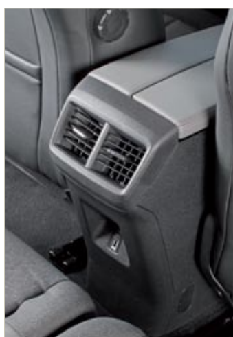
▲ En el salpicadero hay ocho toberas de aireación –en realidad son cuatro dobles–, y detrás también hay aireadores centrales. La segunda fila está formada por tres butacas independientes e iguales, y cada una tiene múltiples ajustes. Los asientos son muy cómodos, pero deberían sujetar un poquito más.
