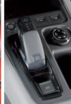
▲ El motor BlueHdi 180 sólo está disponible con la caja automática EAT8, que podemos usar manualmente y tiene levas. Además, hay tres modos de conducción.
