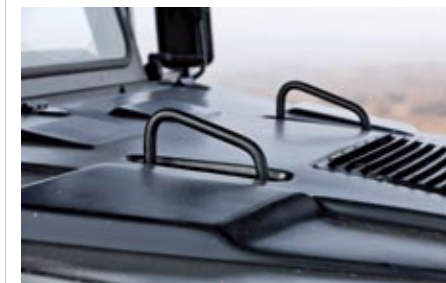
▲▲ El Vamtac S3 va provisto de unas argollas preparadas para ser izado y transportado por un helicóptero Chinook del Ejército.
