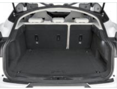
▲ Aunque la marca habla de 656 litros, el maletero tiene 505 litros. Delante hay otro pequeño hueco.
