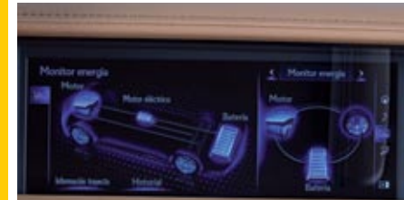
▲ La pantalla de 8 pulgadas circular del cuadro se desliza lateralmente y cambia el contenido de la información. En Sport+, una luz roja nos avisa para que cambiemos de marcha sin llegar al corte. La pantalla del salpicadero es de 10,3 pulgadas.
