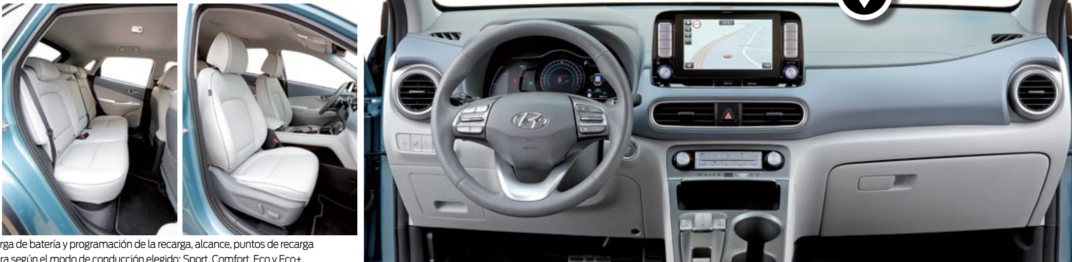
▲▲ Las levas del volante no son para cambiar, sino para elegir el nivel de retención al decelerar: la derecha lo reduce o anula; y la izquierda lo incrementa... e incluso sirve de freno.
