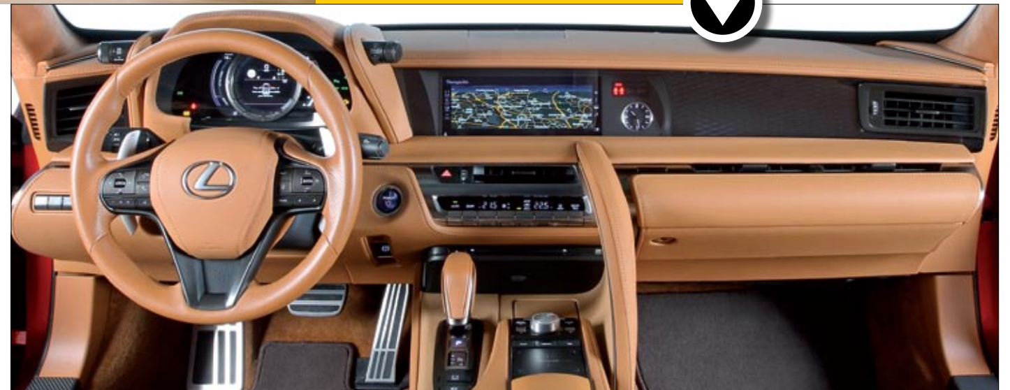
▲ La pantalla de 8 pulgadas circular del cuadro se desliza lateralmente y cambia el contenido de la información. En Sport+, una luz roja nos avisa para que cambiemos de marcha sin llegar al corte. La pantalla del salpicadero es de 10,3 pulgadas.
