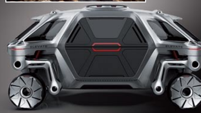
El Hyundai Elevate está compuesto por una plataforma a la que se pueden acoplar diferentes cabinas según el uso que se quiera dar al vehículo. Puede circular, caminar y trepar.
