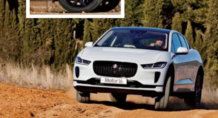
▲▲ La suspensión neumática, de serie en los I-Pace First Edition y HSE, es opcional –1.607 euros– en el resto, y es decisiva de cara a posibles usos 'off road'. Desde 105 km/h baja la altura un centímetro.
