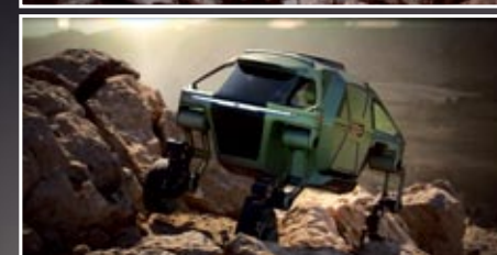
El Hyundai Elevate está compuesto por una plataforma a la que se pueden acoplar diferentes cabinas según el uso que se quiera dar al vehículo. Puede circular, caminar y trepar.
