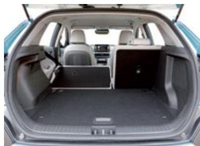
▲▼ Maletero de 332 litros, ampliable a 1.114 gracias al respaldo trasero 60:40. La toma de carga eléctrica va en el frontal, y admite recargas rápidas de 100 kW: 54 minutos.
