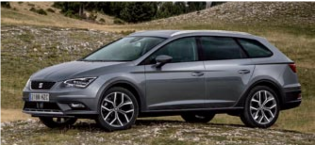
► Este modelo eleva 15 milímetros la altura libre al suelo respecto al León ST, y se rodea de protecciones para poder salir del asfalto.
