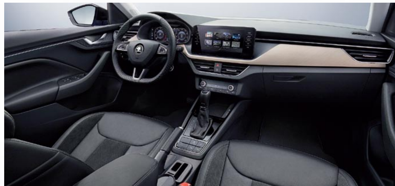
▲ En opción se ofrece la instrumentación configurable Virtual Cockpit, con pantalla de 10,25 pulgadas. Y la pantalla central táctil, que sobresale del salpicadero para facilitar su manejo, puede ser de 6,5 o de 9,2 pulgadas.
