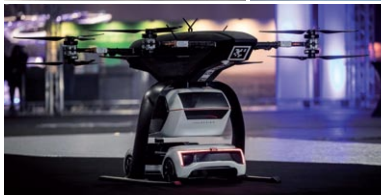
▲▲ El proyecto de taxi aéreo de Audi combina un dron de pasajeros con un automóvil eléctrico de conducción autónoma. De momento, es un prototipo a escala 1:4.
