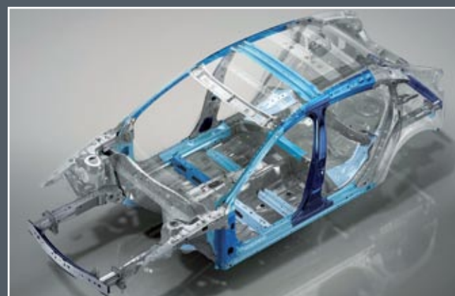
▲ El uso de aceros de ultraalta resistencia se ha multiplicado por diez: si antes suponían el 3 por ciento del bastidor, ahora son ya el 30 por ciento.
