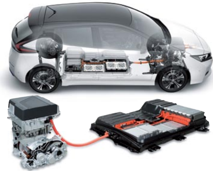
▲ El nuevo motor eléctrico proporciona ahora una potencia de 150 caballos; y la batería, con mucha más densidad energética, permite recorrer con una sola carga hasta 415 kilómetros si el recorrido se realiza en territorio urbano.
