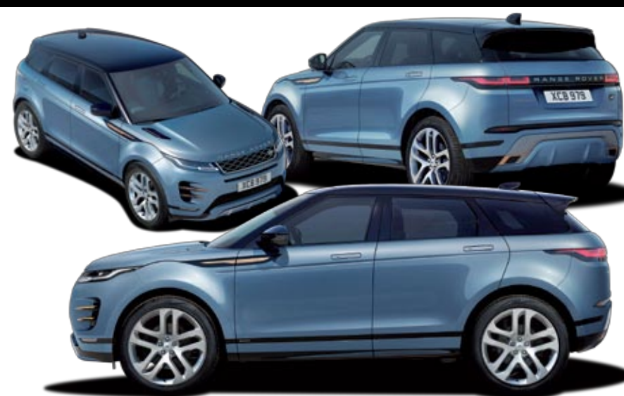
▲ La longitud no varía —4,37 metros—, pero la distancia entre ejes crece 21 milímetros y se acortan voladizos. La altura al suelo, 21,2 centímetros.
