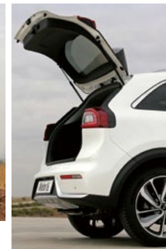
◀▲ En función del acabado elegido, las llantas son de 18 pulgadas –en la foto– o de 16. Los dos motores suman 141 caballos.
