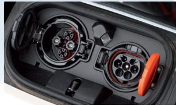
▼▲ A la izquierda, la toma de corriente de tipo ChaDeMo de carga rápida disponible en el Leaf de 40 kWh. Y a la derecha, la toma de carga semirrápida o lenta.
