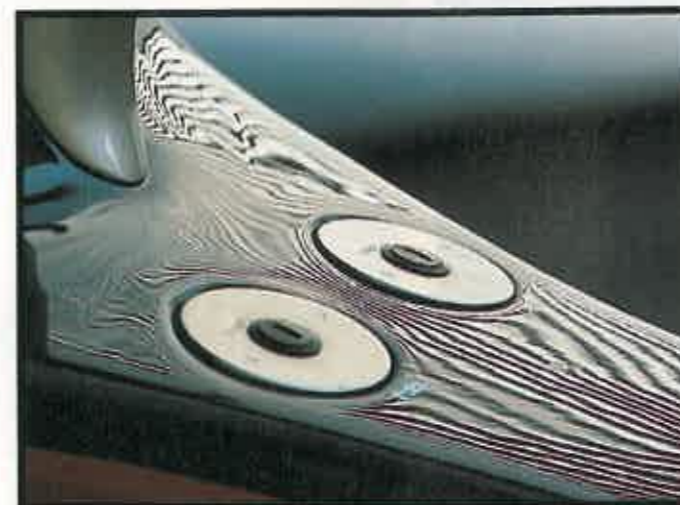
ACEITE Y GASOLINA Dos tapones colocados en la viga central dan acceso a los depósitos.
