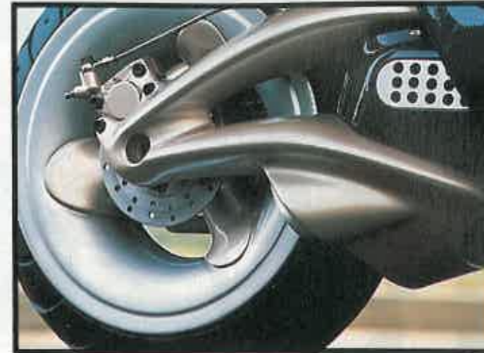
TÉCNICA Y DISEÑO El basculante en fibra de carbono incorpora el tubo de escape.
