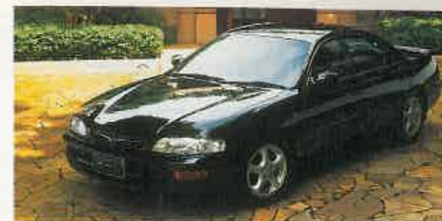
TOYOTA CORONA Exiv Esta es también una versión especial que sólo está prevista para el mercado local japonés. Sus diferencias radican en el equipamiento y dispone de un motor de cuatro cilindros y dos litros de capacidad con culata de cuatro válvulas por cilindro.
