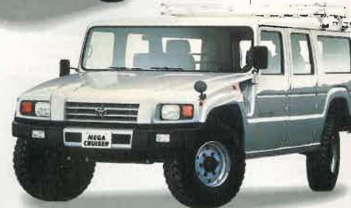
TOYOTA MEGACRUISER Se podría decir que se trata de la réplica japonesa del Hummer americano. Tiene un imponente motor de 4,1 litros con inyección directa turbodiesel y suspensión independiente.
