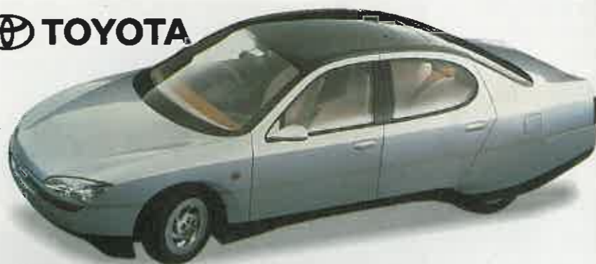
TOYOTA AXV-V Esta es la última versión del prototipo de coche para desplazamientos interurbanos. Destaca por un coeficiente aerodinámico de 0,20 y un motor de cuatro cilindros con un avanzado sistema de inyección directa de gasolina.
