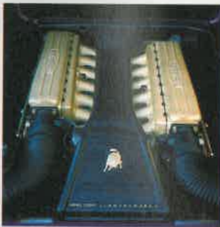
UNA BELLEZA. Se trata del V12 Lamborghini con una cilindrada de 5,7 litros y 525 caballos de potencia, un motor de una belleza indudable.
