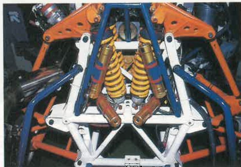
A TODA PRUEBA El sistema de amortiguación posterior tiene reminiscencias de las utilizadas en motocross con un recorrido de 30 centímetros.
