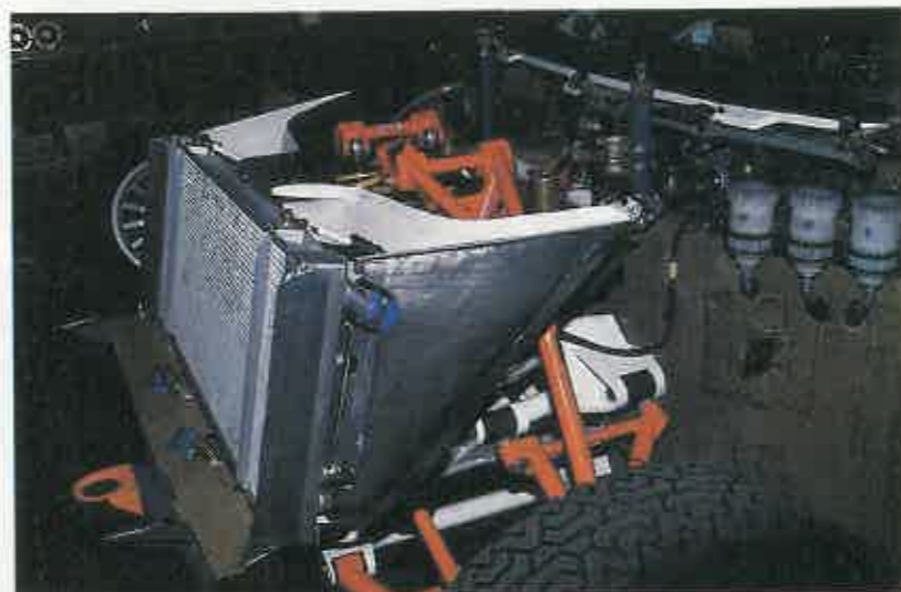
EL RADIADOR MÁS LLAMATIVO El Toledo Marathon incorpora nueve radiadores para los diversos líquidos, el del agua situado en el frontal es el de mayor tamaño
