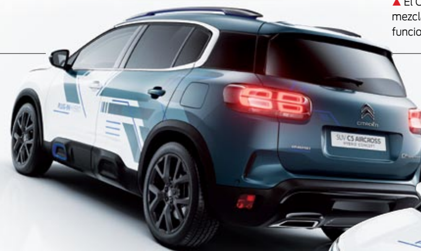
▲ El siguiente paso en la estrategia de electrificación de Citroën es este C5 Aircross Hybrid Concept, un híbrido enchufable de 225 caballos, con 50 kilómetros de autonomía eléctrica. Llega al mercado en 2020.
