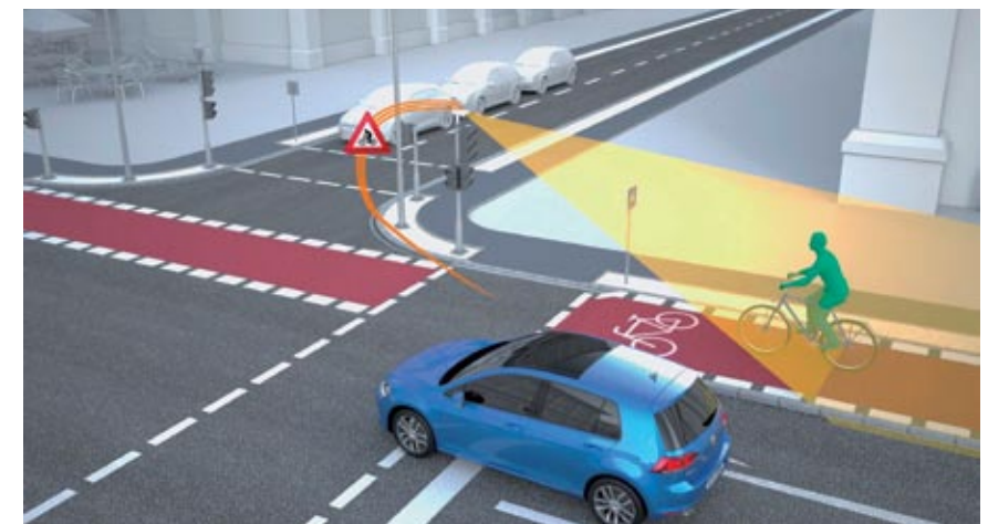
▲ La comunicación del vehículo con las infraestructuras dará al conductor una información que el coche solo no ofrece: vehículos en puntos ciegos, peatones frente a un paso de cebra...
