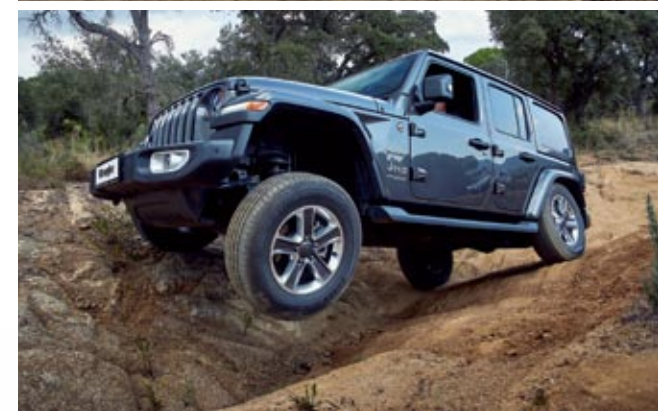
▲ Arriba, el Rubicon, con reductora más cerrada, bloqueo delantero y desconexión de la estabilizadora delantera. Debajo, la versión Sahara.
