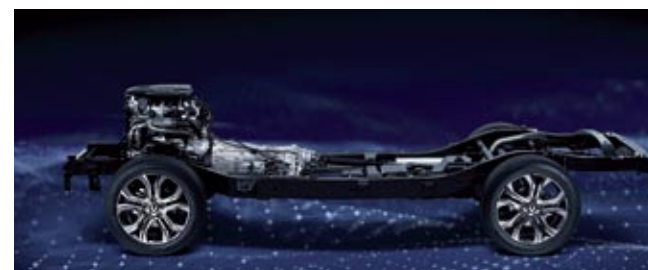
▲ El Rexton mantiene una arquitectura sencilla para su chasis, de largueros y travesaños, ahora con un eje trasero multibrazo.
