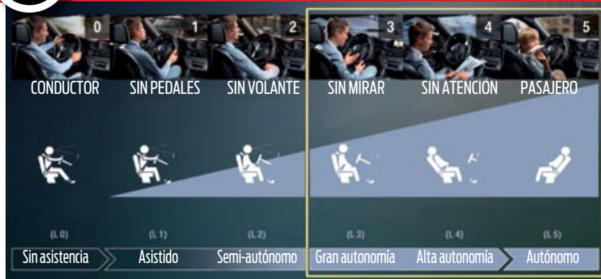
▲ En la conducción automatizada se distinguen cinco niveles, con el 5 como estadio final. Su implantación dependerá de la legislación de cada país.
