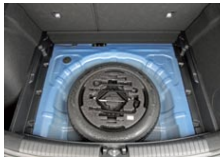
▲ Maletero de 395 litros, y podemos poner el suelo a dos alturas distintas –en la superior, la zona de carga es casi plana al abatir el respaldo–. Debajo va una rueda de repuesto.
