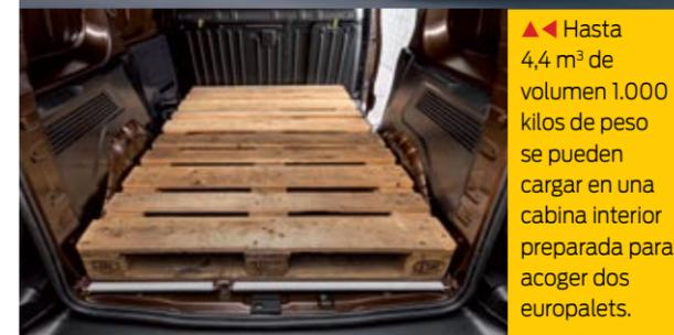
▲▲ Hasta 4,4 m<sup>3</sup> de volumen 1.000 kilos de peso se pueden cargar en una cabina interior preparada para acoger dos europalets.
