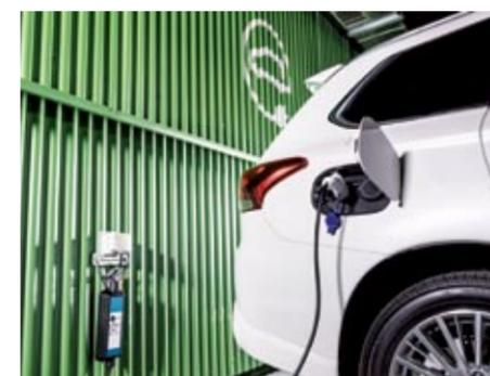
◀ Su motor eléctrico trasero pasa de 82 a 95 CV, y en modo 'EV' alcanza 135 km/h. En un enchufe normal se recarga en 5,5 horas, pero ojo porque su toma no se bloquea al cerrar el coche.
