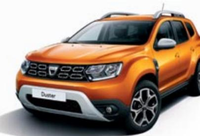
**DACIA DUSTER 1.3 TCE.** - El Duster estrena el motor de gasolina 1.3 Tce con inyección directa y dotado de filtro GPF. Disponible en dos variantes –130 CV y 24,5 mkg de par, y 150 CV con 25,5 mkg–, primero se ofrecerá con tracción 4x2 y luego con 4x4.
