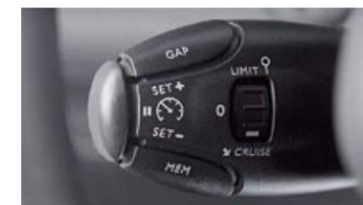
▲ El control de velocidad adaptativo mantiene la distancia respecto al coche de delante.
