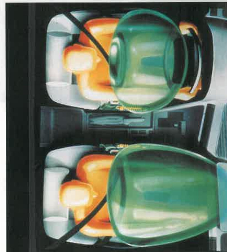
TODO CALCULADO A pesar del mayor volumen del airbag del pasajero, tardan lo mismo en inflarse completamente, sincronizados con el pretensado de cinturones.
