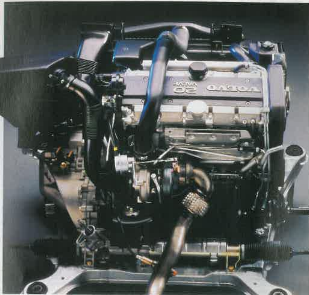
MENUDO CINCO CILINDROS. El nuevo motor turbo destaca por un elevado par motor que se alcanza en un amplio margen de revoluciones. Se ha buscado más la progresividad que la potencia bruta.
