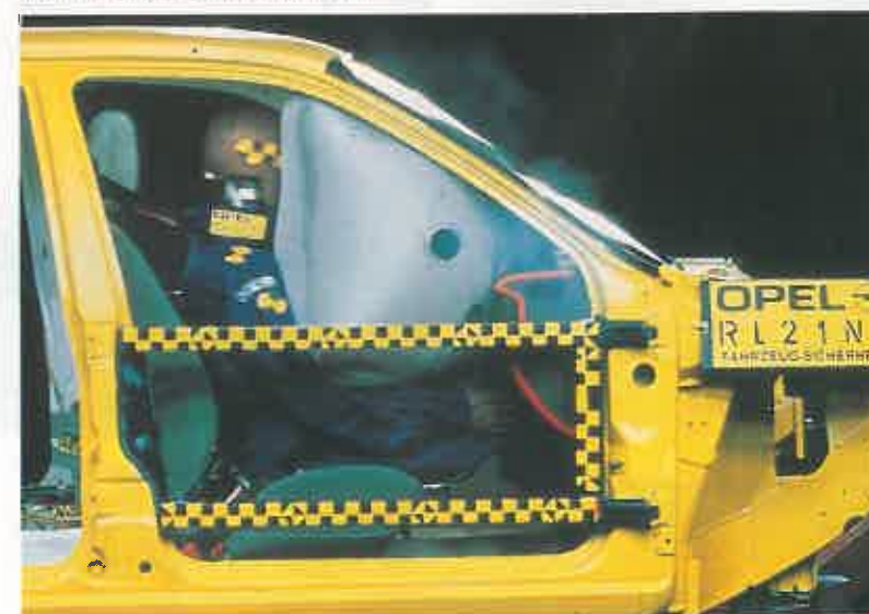
SISTEMA INTELIGENTE El airbag sabe distinguir entre una «falsa alarma» como el paso de bordillos o bruscos frenazos y una auténtica colisión contra otro vehículo u obstáculo. Los maniqués Hybrid han experimentado en sus sensores la eficacia del sistema.
