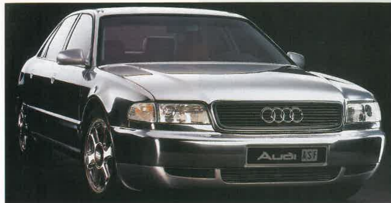
TODO ALUMINIO El Audi ASF es un «concept car» cuya carrocería está construida en aluminio, en su totalidad.
