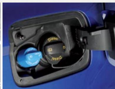
▲ La instrumentación nos informa sobre la autonomía del depósito de AdBlue, aditivo que minimiza la emisión de óxidos de nitrógeno. La boca de llenado está junto a la del gasóleo.
