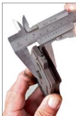
◀ Los discos delanteros han sufrido un desgaste nulo en estos 25.000 km; mientras que las pastillas de freno delanteras han perdido sólo un milímetro de grosor.
