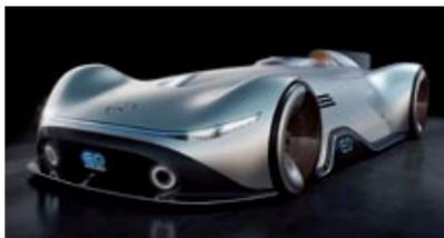
**MERCEDES EQ SILVER ARROW.-** Se presentaba hace unos días en California y enseña la línea de diseño futura de la casa alemana. Este monoplaza eléctrico rinde 750 CV y su batería de 80 kWh ofrece un alcance superior a los 400 kilómetros.
