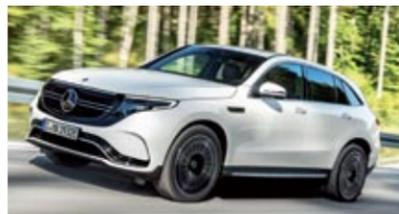
**MERCEDES EQC.-** A mediados de 2019 será el primer modelo EQ, nombre del nuevo sello de movilidad eléctrica de la casa. Monta dos propulsores eléctricos, uno en cada eje, para dotar al conjunto de tracción total, con una potencia conjunta de 408 CV.
