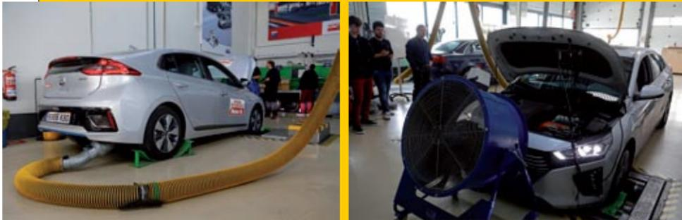
▲ Un buen número de becarios de electromecánica observan con detenimiento la labor de los ingenieros de Bosch preparando el Ioniq Plug-in en el Banco de Potencia de la marca alemana.
