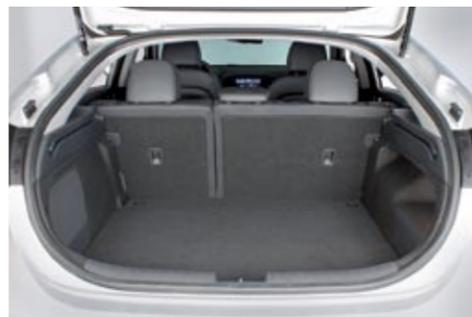
◀ El maletero del Ioniq Plug-in reduce su volumen 100 litros para alojar en su doble fondo otra batería para ir más tiempo en modo EV. El freno de pedal ya no se estila en Europa. No hay limpiacristales trasero.
