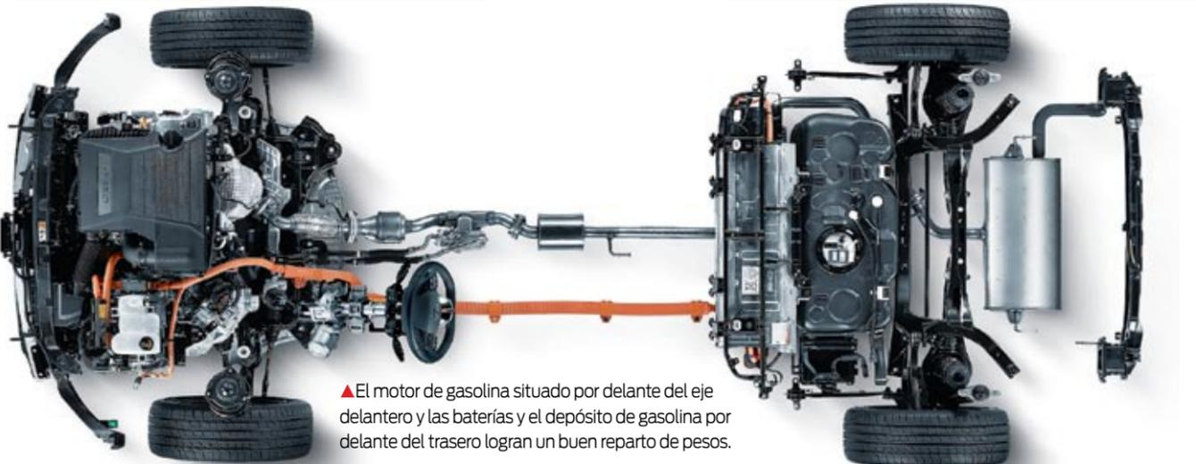
▲ El motor de gasolina situado por delante del eje delantero y las baterías y el depósito de gasolina por delante del trasero logran un buen reparto de pesos.
