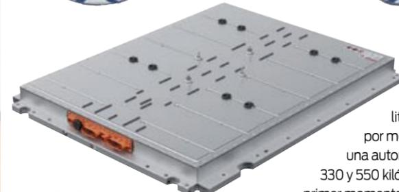
▲▼ La batería de iones de litio es escalable por módulos y ofrece una autonomía de entre 330 y 550 kilómetros... en un primer momento. La capacidad mínima parte desde los 48 kWh. El primer modelo de la familia será un compacto tipo Golf que nacerá desde este prototipo.
