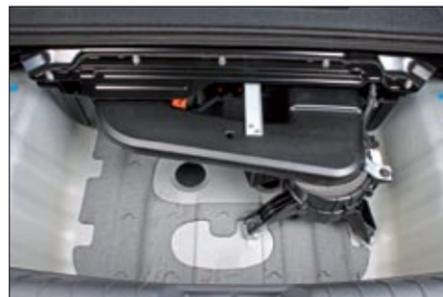
◀ La batería del Ioniq PHEV está dividida en dos módulos, uno situado bajo la banqueta trasera (1), que lleva su propio impulsor. Y el segundo (2) va en el maletero, con un sistema de refrigeración que utiliza el aire del habitáculo aspirando por la rejilla que mostramos en la foto de la derecha.
