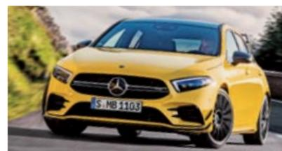
**MERCEDES AMG A 35 4MATIC.** - Se convierte en el modelo de acceso al universo AMG y presume de un nuevo bloque 2.0 sobrealimentado que rinde 306 CV. Cambio de doble embrague, tracción total y unas prestaciones que dan vértigo.
