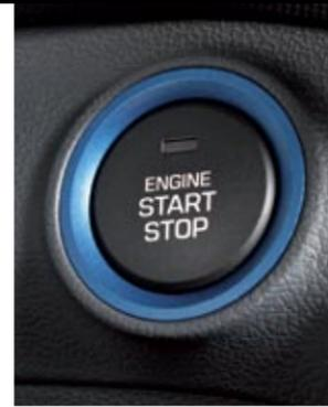
▲ Como buen vehículo moderno, el Ioniq se arranca o se para por medio de un botón.
