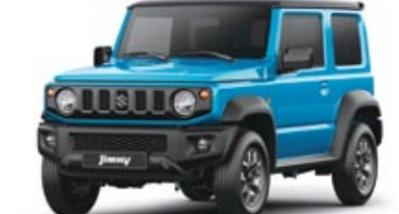
**SUZUKI JIMNY.-** Este coqueto todoterreno de bolsillo mide 3,65 metros y presenta un robusto bastidor de largueros y travesaños. Monta una avanzada tracción total con caja reductora, y se ofrecerá un único motor de gasolina, de 102 CV.
