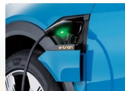
(ver recuadro) – que se traduce en una autonomía de más de 400 kilómetros según el nuevo ciclo de homologación WLTP. Esa autonomía se consigue gracias a una batería de 95 kWh que cuenta con 36 módulos de celdas de aluminio y que va ubicada bajo el habitáculo. Con un tamaño de 2,28 metros de longitud y un peso de 700 kilos, su ubicación ayuda a mejorar la rigidez de la carrocería y también baja el centro de gravedad.
