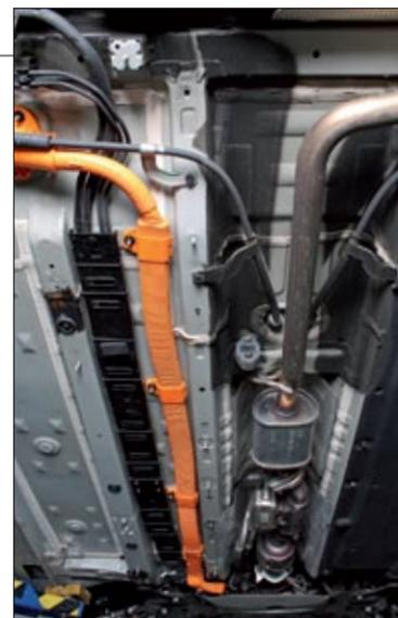
▲ El cableado de alta tensión que une el motor eléctrico con las baterías está bien protegido, y luego cubierto por una tapa.
